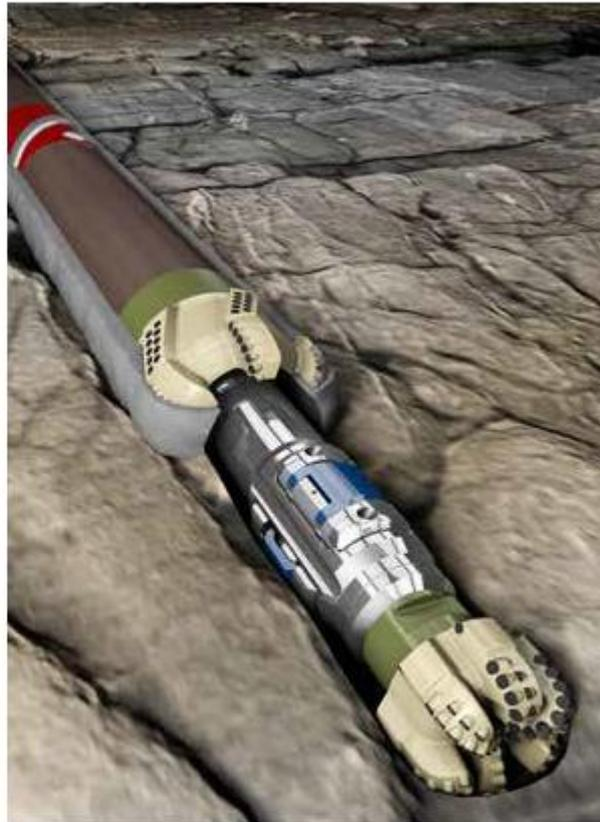
b) izvršena je cementacija, dlijeto se može probušiti sa PDC dlijetom i nastavlja se daljnje bušenje
