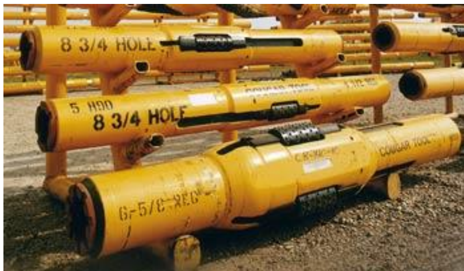
Slika 2-4. Proširivač s valjcima ( http://www.cougards.com )
