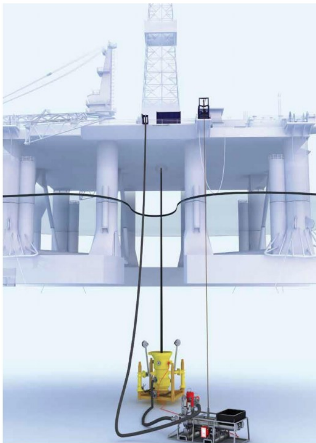
Slika 4-11. Metoda povrata isplake bez rajzer cijevi (www.enhanced-drilling.com).
