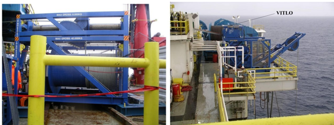
Slika 6-10. Vitlo nosivosti 25 t (lijevo) i vitlo nosivosti 10 t (desno) (Smith et al., 2010).
