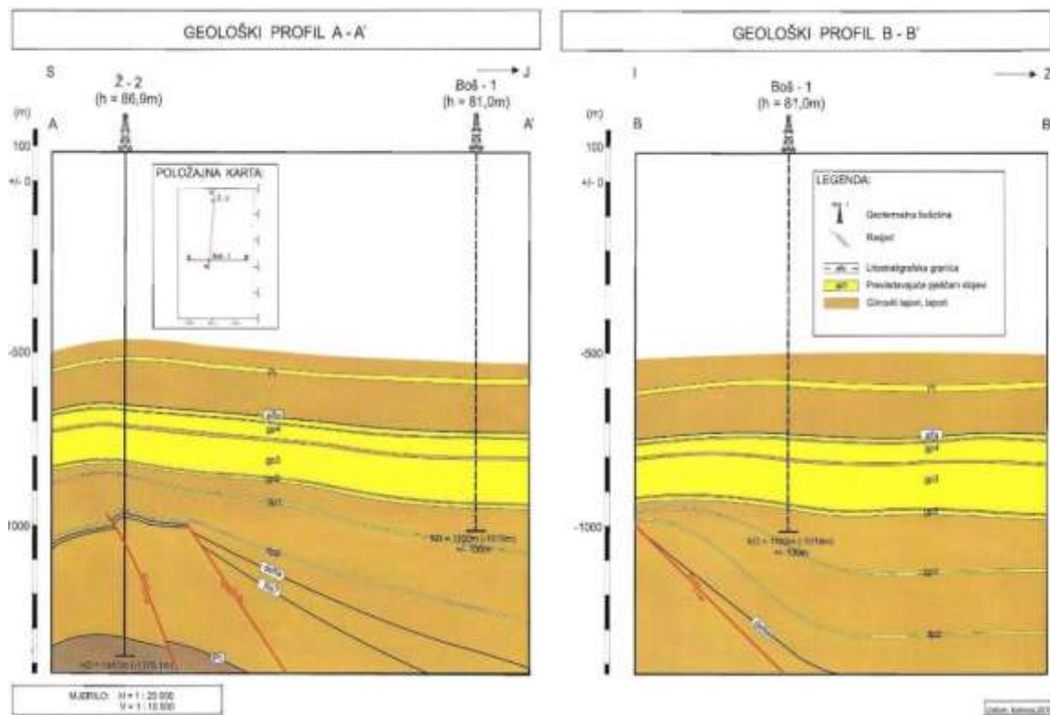
**Slika 3-7.** Geološki profili: AA' koji povezuje projektiranu bušotinu Boš – 1 s najbliže korelativnom bušotinom Ž – 2 i poprečni profil BB' koji prikazuje projektiranu bušotinu Boš – 1 (Kolbah i Škrlec, 2012)
