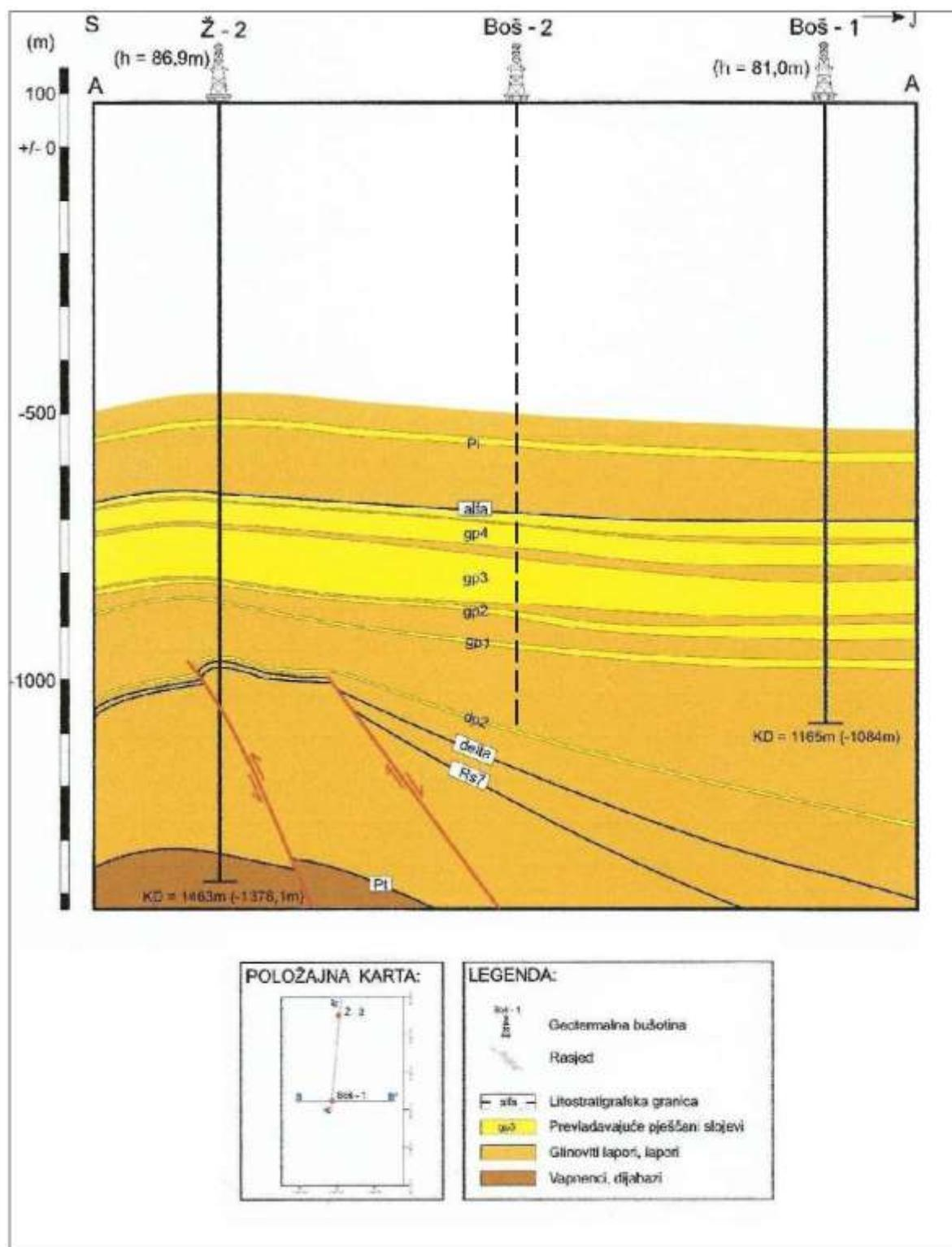
**Slika 4-12.** Geološki profil s bušotinom Boš-2 s prepostavljenom udaljenosti između bušotina Boš – 1 i Ž – 2. Županjski pješčenjaci se nalaze u formaciji Vera između neformalnih repera Delta i Alfa. Po klasifikaciji koja vrijedi upravo u Slavonsko-srijemskoj depresiji to se EK markeri «A» (korelativan s «Alfa») i «B» (korelativan s «Delta»)
