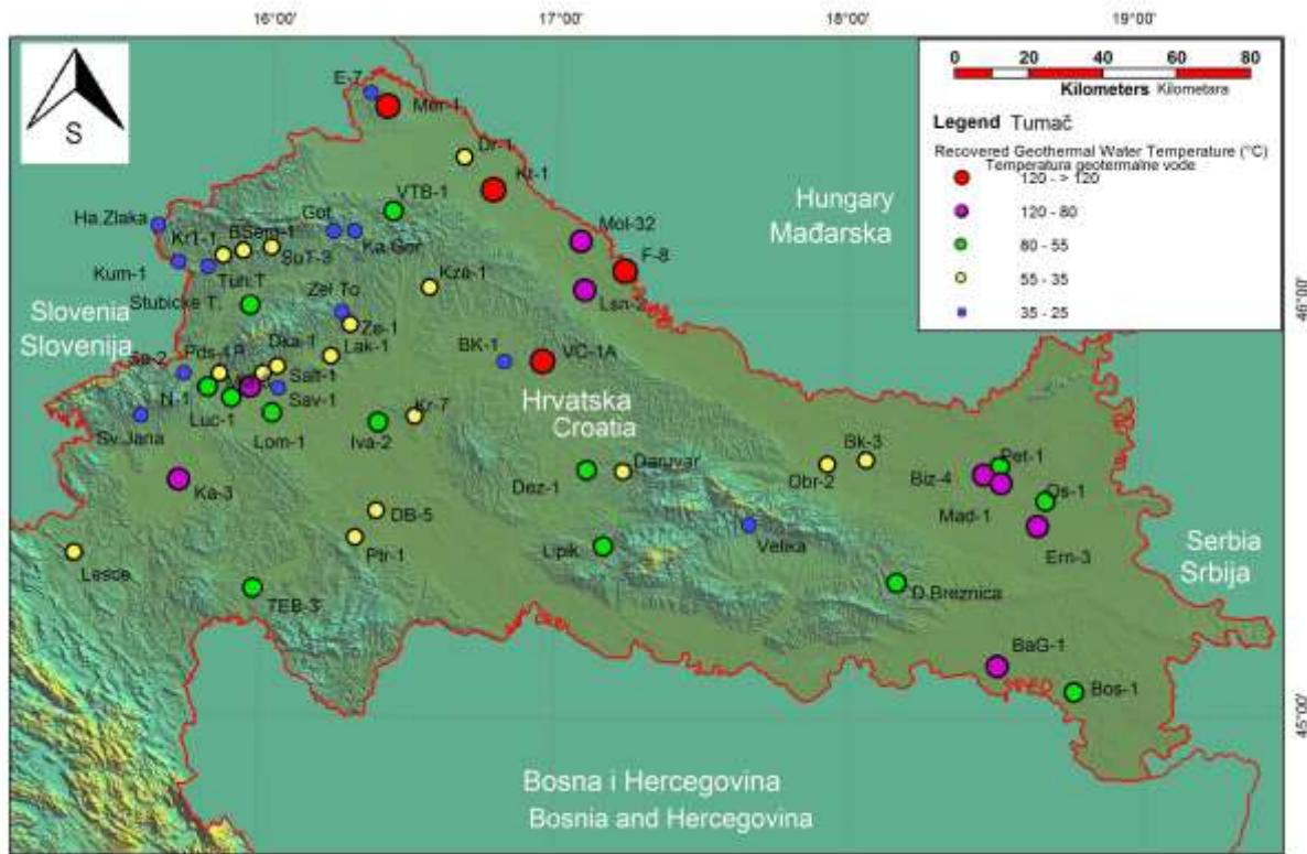
**Slika 2-3.** Toplice i lječilišta te lokaliteti bušotina s geotermalnim potencijalom temperature geotermalne vode dobivene ili očekivane na površini, a prikazane odgovarajućom bojom prema legendi, na hrvatskom dijelu Panonskog bazena (Živković et al., 2015)
