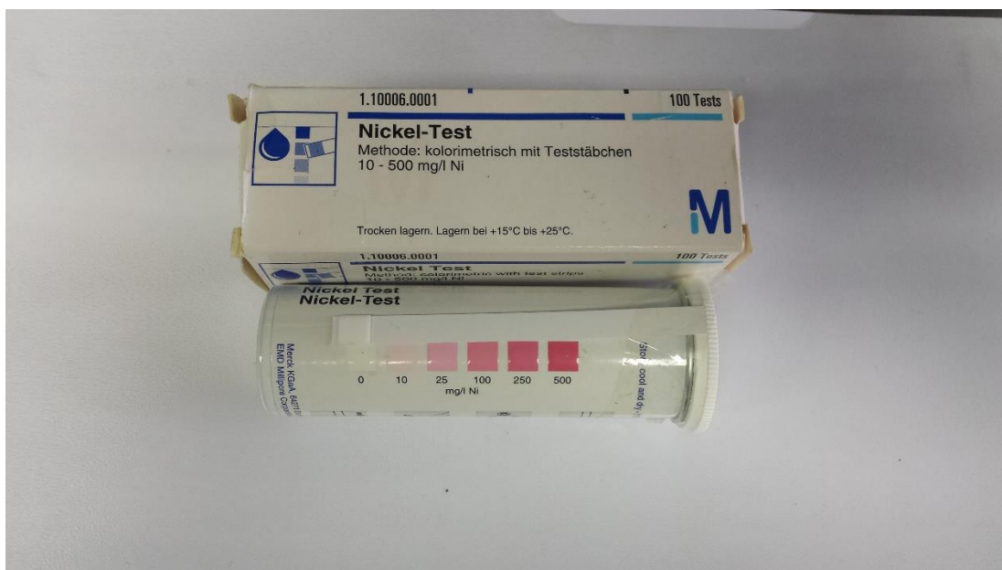
Slika 7-1. Kolorimetrijska kvantitativna metoda dokazivanja nikla.
