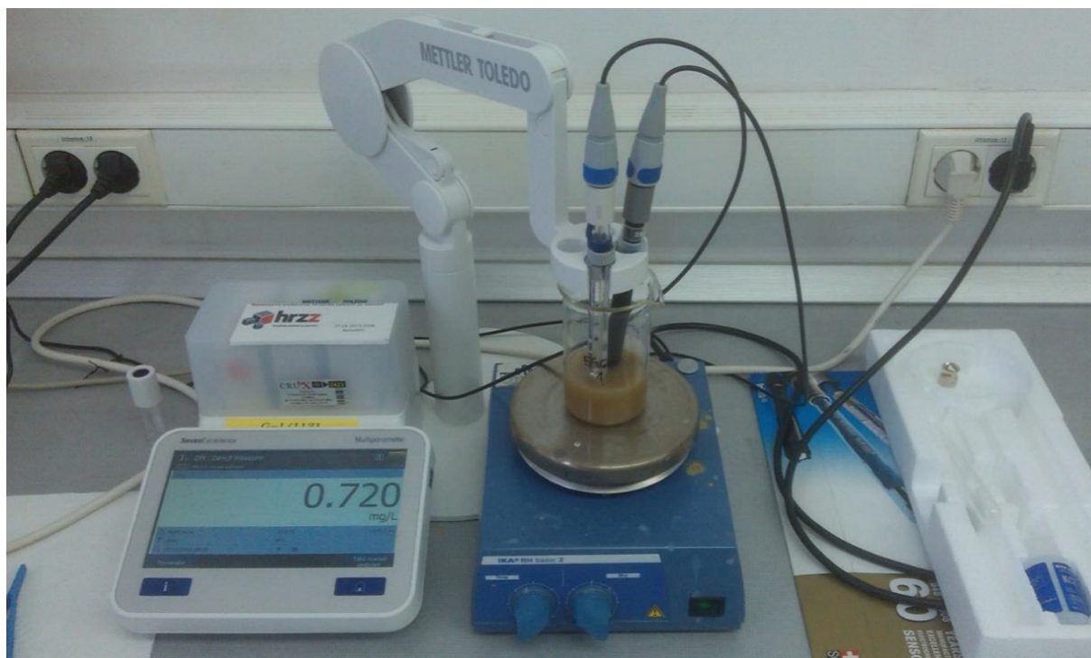
Slika 4.5. Mjerenje kapaciteta kationske izmjene (foto:Dražen Tumara)
