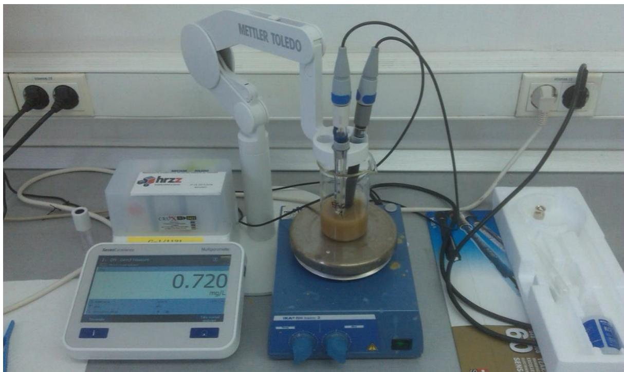
Slika 4.5. Mjerenje kapaciteta kationske izmjene (foto:Dražen Tumara)
