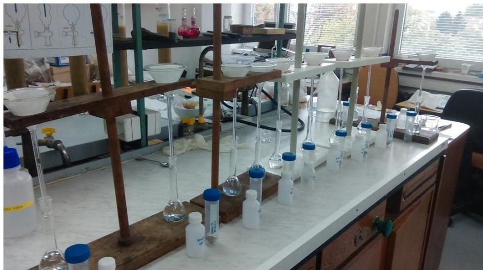
Slika 4.6. Filtriranje uzoraka tijekom sekvencijske ekstrakcijske analize (BCR)
