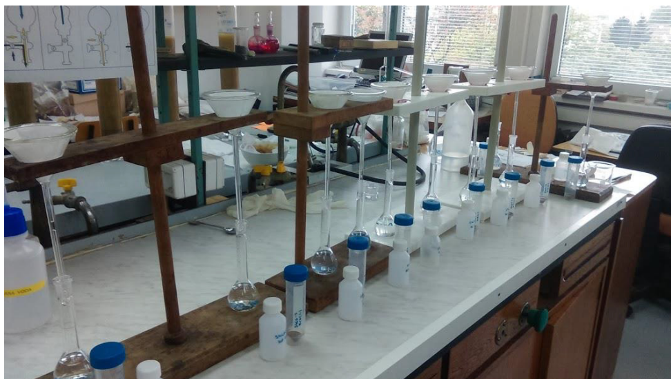
Slika 4.6. Filtriranje uzoraka tijekom sekvencijske ekstrakcijske analize (BCR) (foto: Tin Borovčak)
