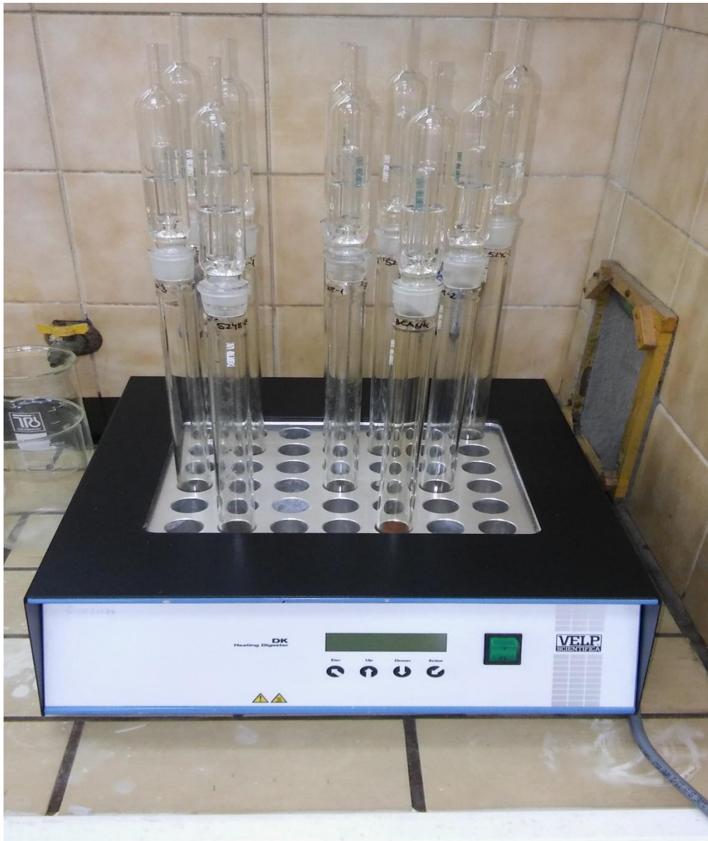
Slika 5-4. Uzorci sa zlatotopkom postavljeni na kupelj od 100°C u digestoru
