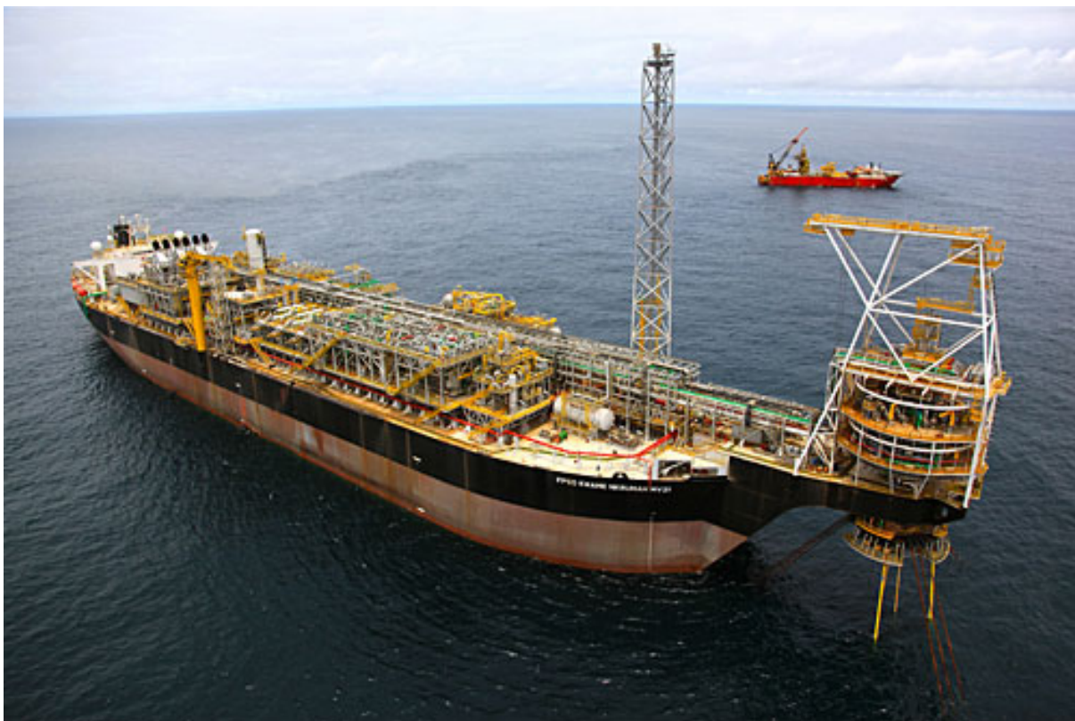
Slika 2-15. Plutajuće postrojenje za proizvodnju, skladištenje i istovar nafte (www.sofec.com)
