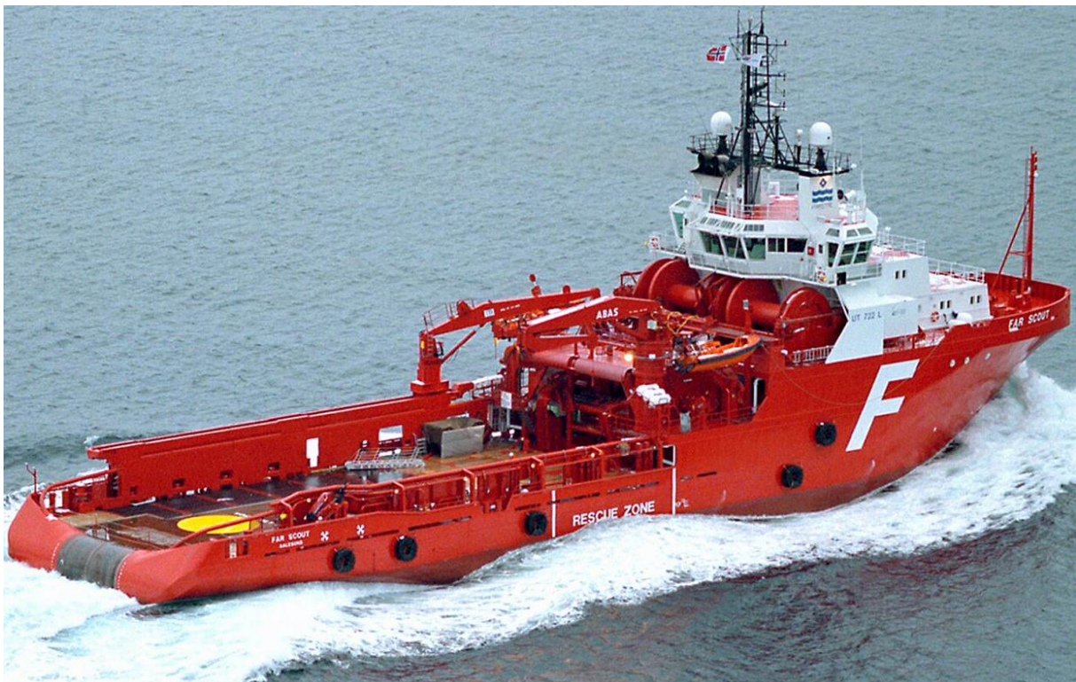
Slika 2-13. Brod za polaganja sidara ( www.memim.com )
