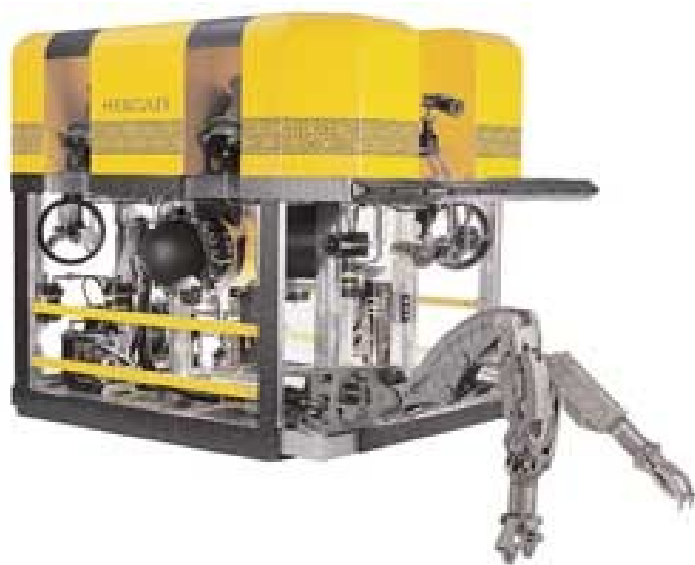
Slika 2-4. Radni ROV „ Hercules “ (www.rovexchange.com)
