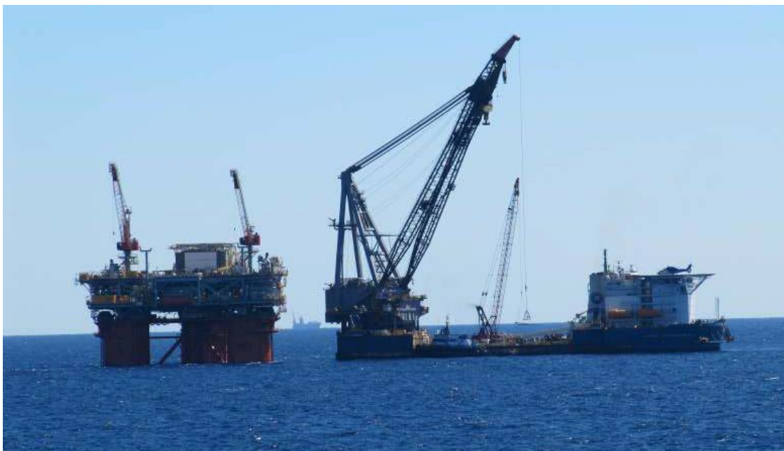
Slika 2-8. Barža s rotirajućom dizalicom (desno) ( www.shipspotting.com )
