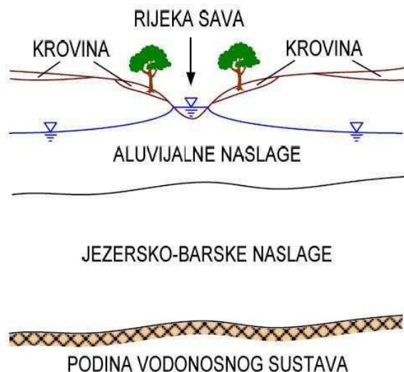
Slika 3.3. Shematski profil zagrebačkog vodonosnog sustava (Posavec, 2006)
