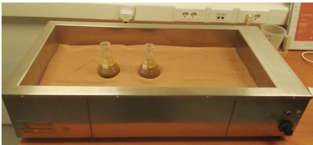
Slika 4-5 Pje-anoj kupelj za provođenje ispitivanja
