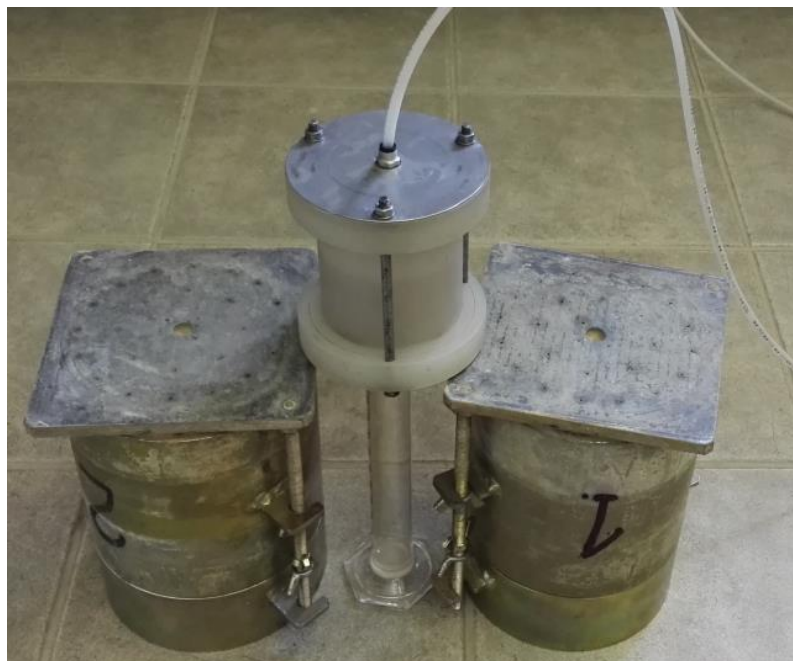
Slika 5-6 Ure aj za ispitivanje gubitka fluida (Geomehani ki laboratorij Geokon-Zagreb)
