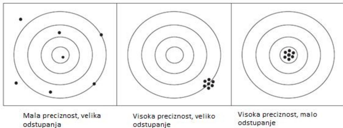
Slika 2-1 Grafički prikaz preciznosti i odstupanja mjerenja
