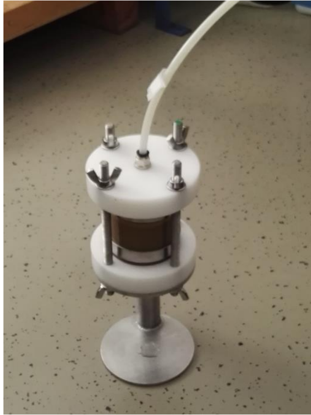
Slika 5-5 Ure aj za ispitivanje gubitka fluida (Geomehani ki laboratorij RGNF)
