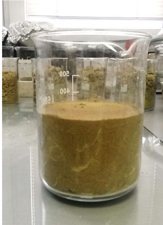
Slika 4-7. Pijesak pripremljen za hidrataciju bentonitne gline
