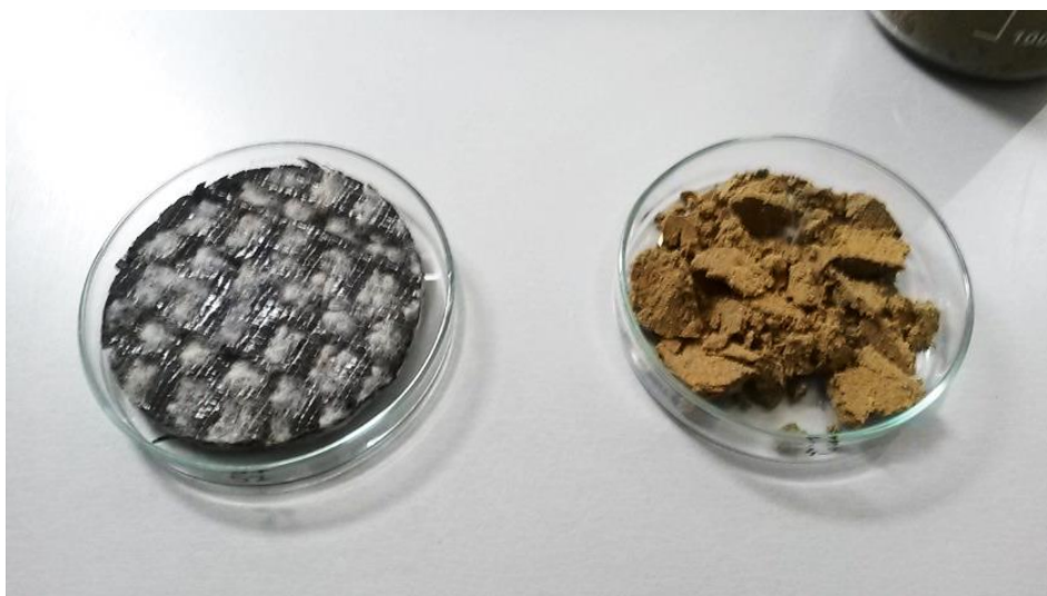
Slika 4-9. Izvađeni uzorak GCL-a i pijesak nakon završetka ispitivanja
