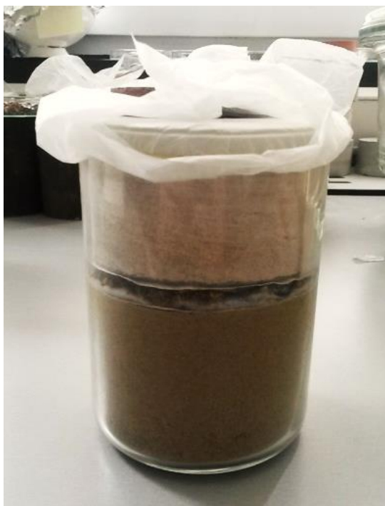
Slika 4-8. Pripremljena posuda sa uzorkom za postupak hidratacije
