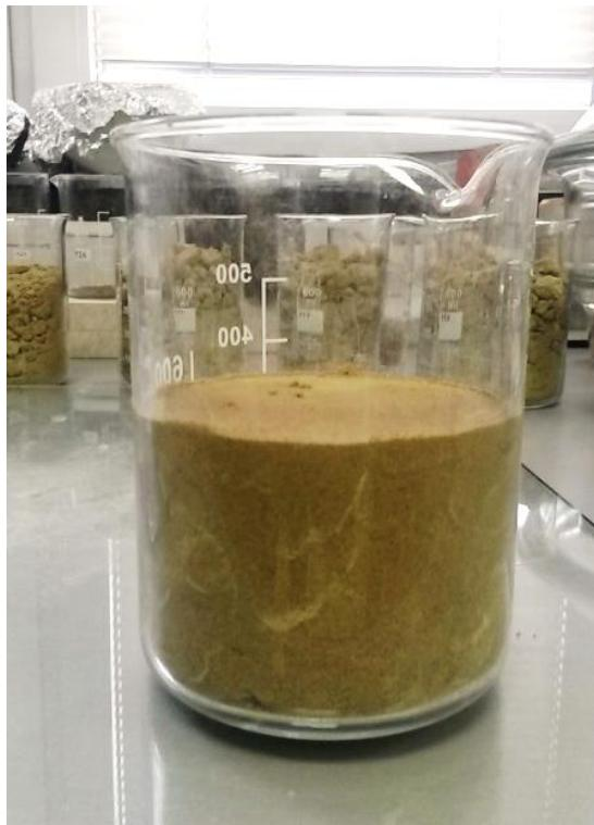
Slika 4-7. Pijesak pripremljen za hidrataciju bentonitne gline
