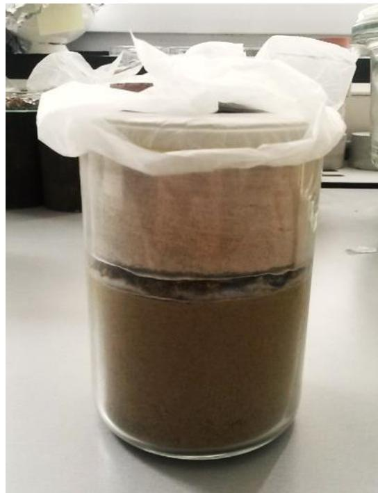
Slika 4-8. Pripremljena posuda sa uzorkom za postupak hidratacije
