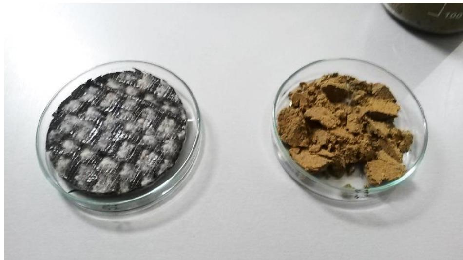
Slika 4-9. Izvađeni uzorak GCL-a i pijesak nakon završetka ispitivanja
