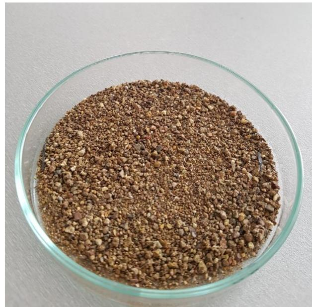
Slika 4-2. Granule bentonitne gline iz uzorka GCL-a (13-001-025)
