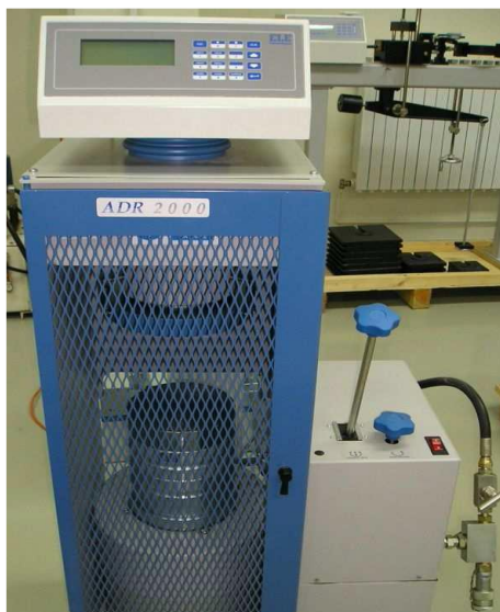
Slika 6-3. Hidraulična preša ELE ADR 2000 (Hrženjak i Briševac 2008).
