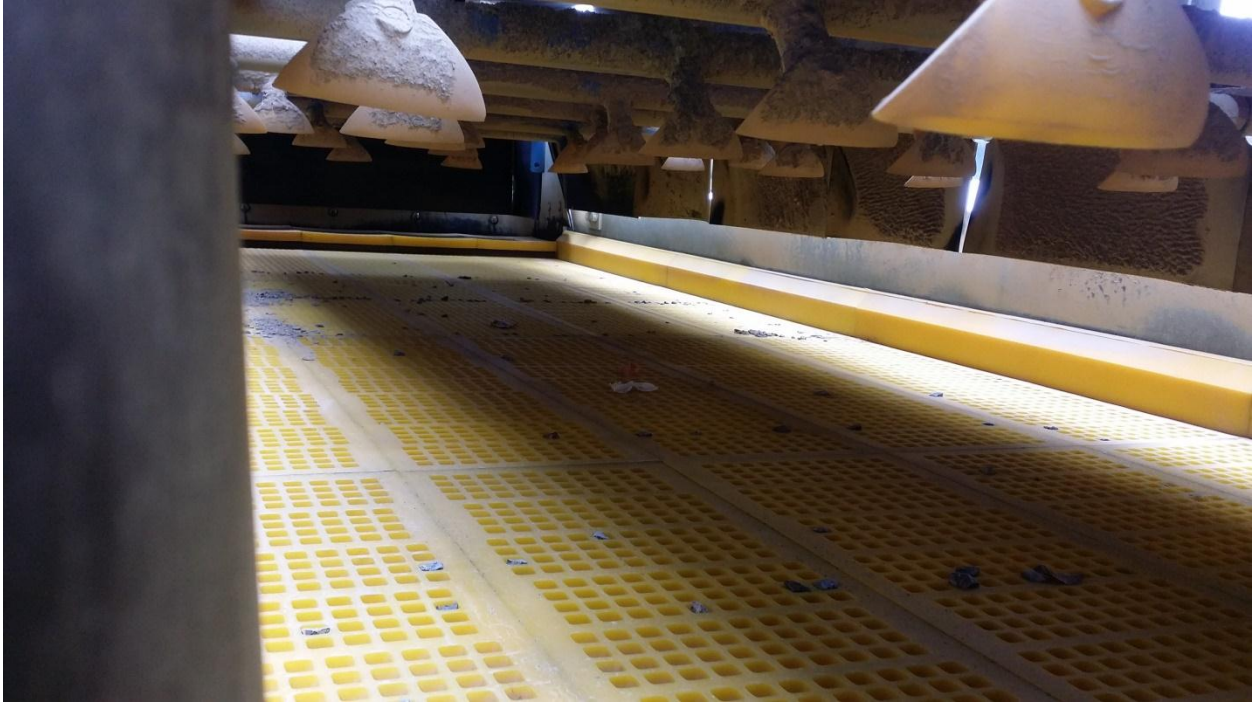
Slika 3-5. Sustav mlaznica i sito od poliuretanskog materijala
