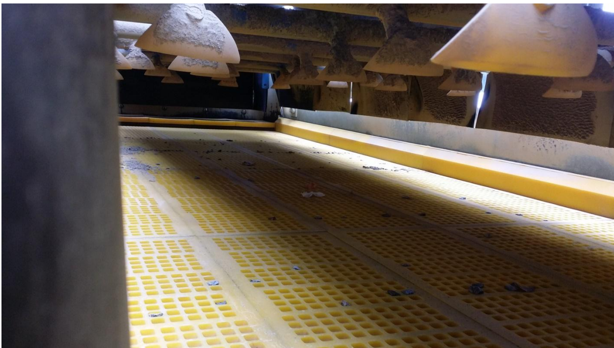
Slika 3-5. Sustav mlaznica i sito od poliuretanskog materijala
