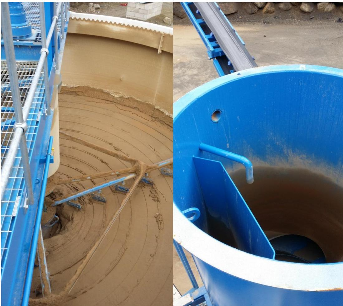
Slika 3-9. Unutrašnjost sedimentacijskog bazena i posuda za miješanje otpadne tehnološke vode i flokulanta
