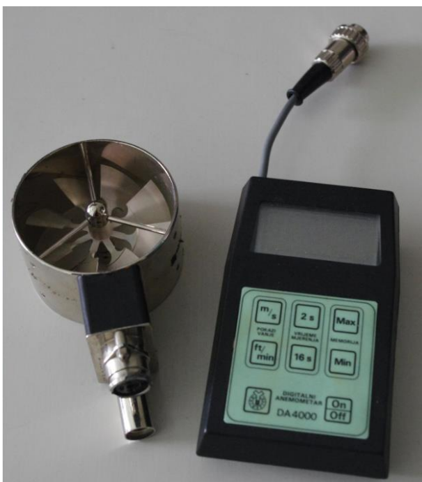
Slika 5-6. Digitalni krilni anemometar DA4000.
