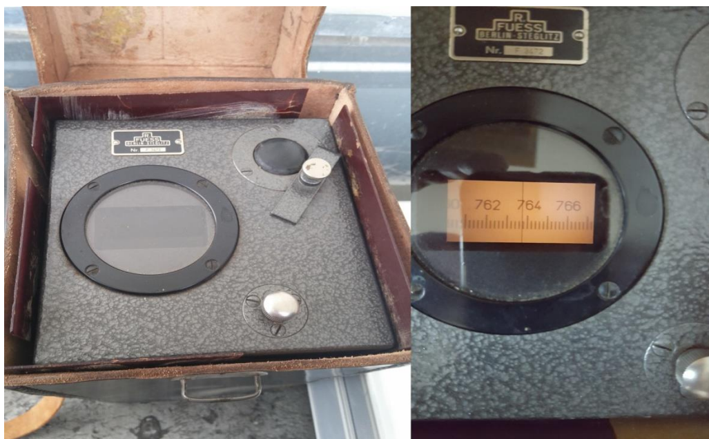
Slika 4-4 Veliki Precizni barometar (R.Fuess Berlin–Steglitz).
