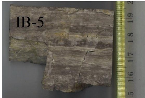
Slika 7.4. Uzorak IB-5 koji pokazuje laminiranu građu i najveće vrijednosti upijanja vode
