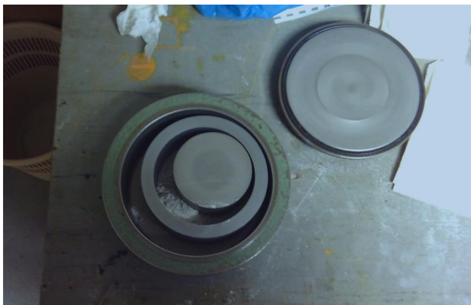
Slika 5.2. Uzorci u mlinu usitnjeni do dimenzija praha
