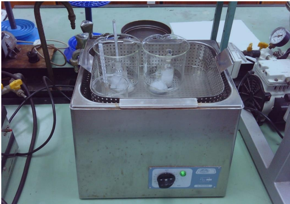
Slika 5.3. Uzorci u piknometrima u ultrazvučnoj kupelji
