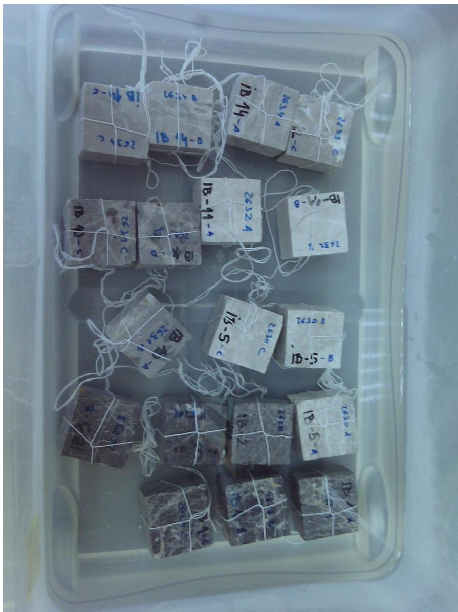
Slika 5.4. Uzorci potopljeni u vodi i zavezani špagom za mjerenje mase pod vodom
