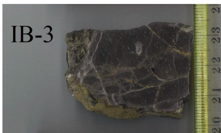
Slika 7.1. Ranodijagenetski uzorak iz kamenoloma Ivanec isprepleten velikim brojem pukotina
