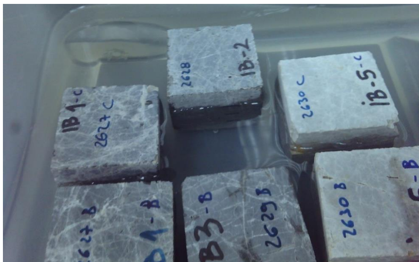
Slika 5.6. Uzorci potopljeni u vodi do 3/4 svoje visine
