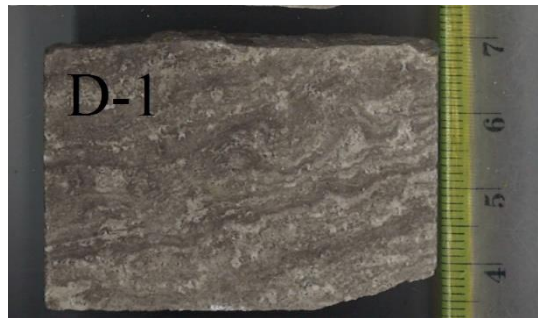
Slika 7.3. Ranodijagenetski uzorak koji pokazuje laminiranu građu
