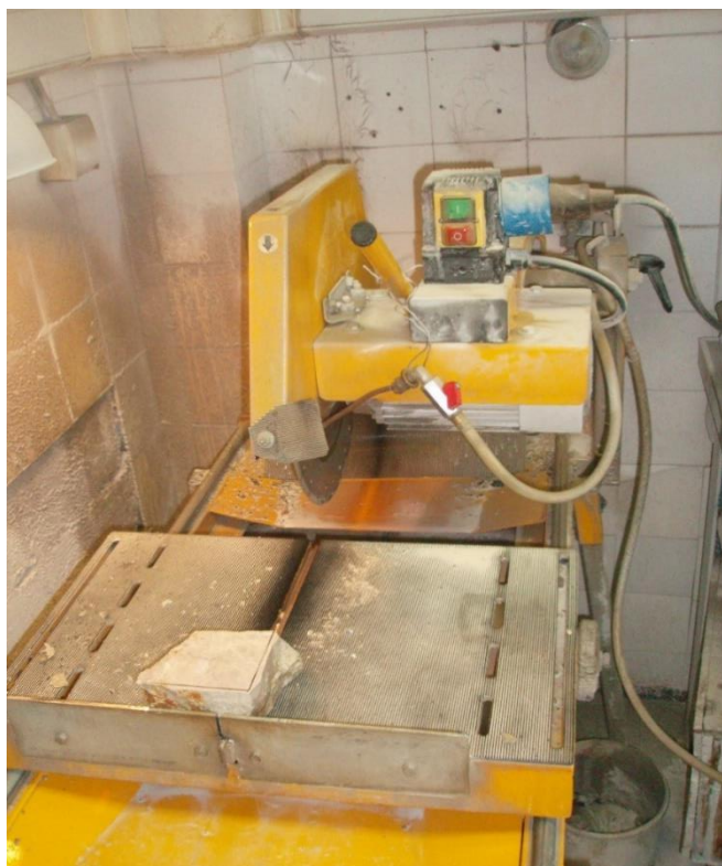
Slika 5.1. Piljenje uzoraka u oblik kocke
