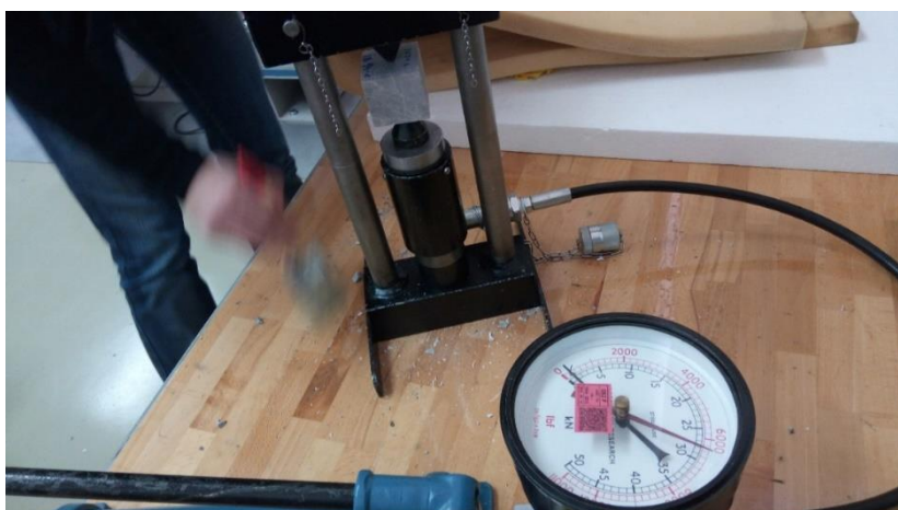
Slika 5.7. Uzorak postavljen za mjerenje PLT čvrstoće
