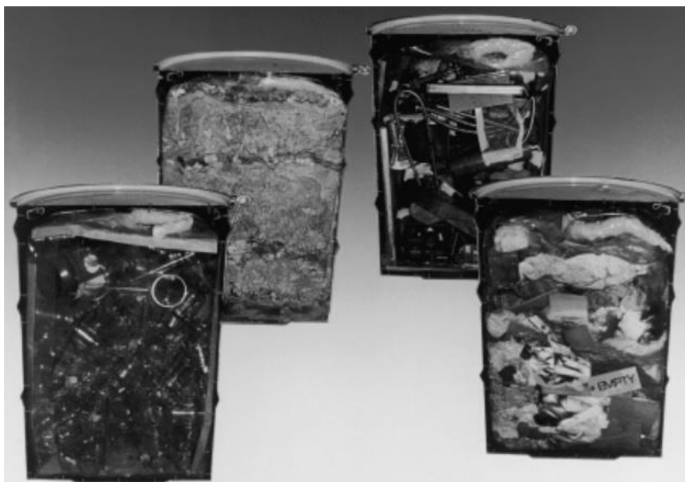
Slika 6-4. Prikaz presjeka bačvi različitog sadržaja radioaktivnog otpada (IAEA, 1998)
