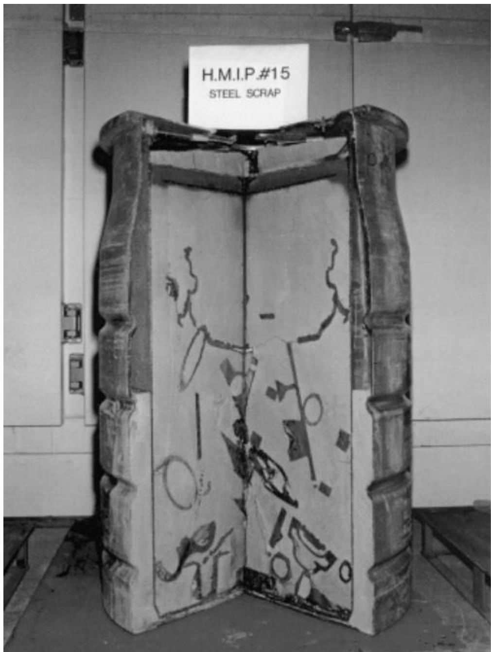
Slika 2-2. Presjek bačve sa radioaktivnim materijalom zalivenim betonom (IAEA, 1998)
