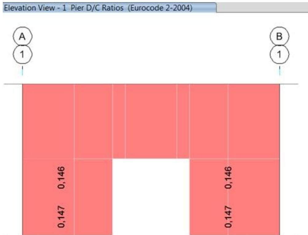
Slika 6-22. Iskorištenje pretpostavljene uzdužne armature u zidu presjeka 1.
