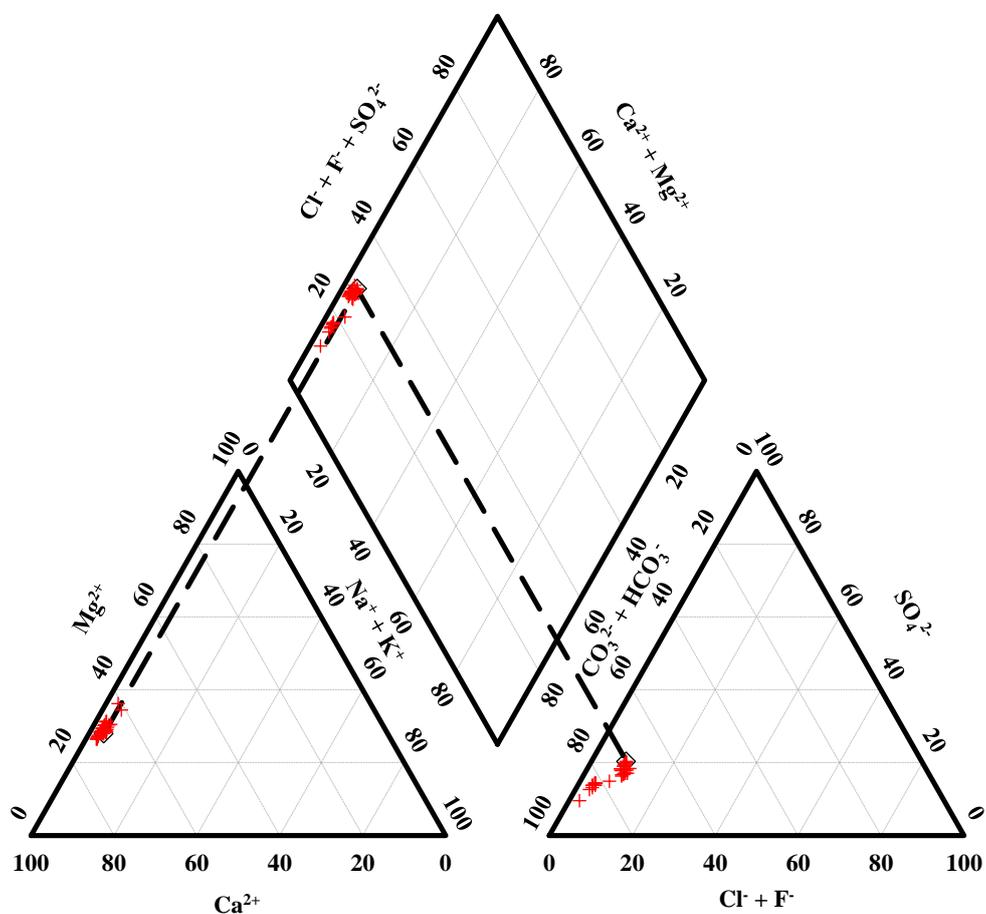
**Slika 6.4.** Piperov dijagram uzorkovanih podzemnih voda sa priljevnog područja crpilišta Prelog
