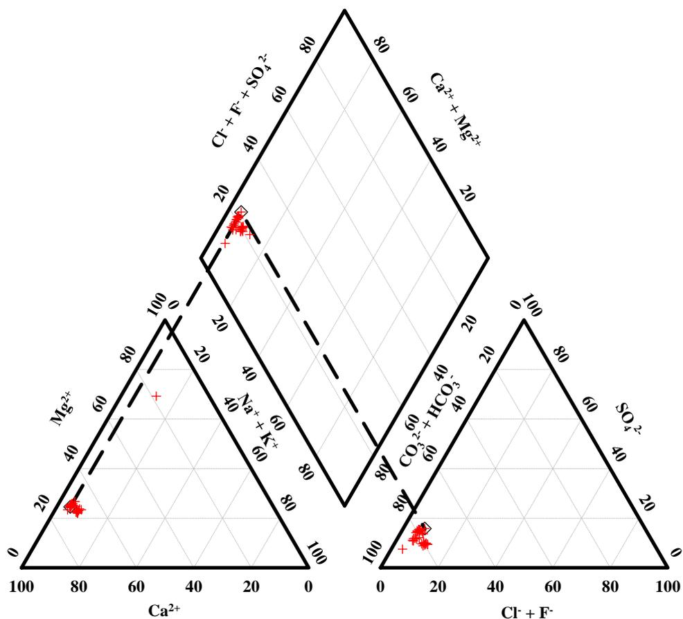
Slika 6.3. Piperov dijagram uzorkovanih podzemnih voda sa priljevnog područja crpilišta Nedelišće
