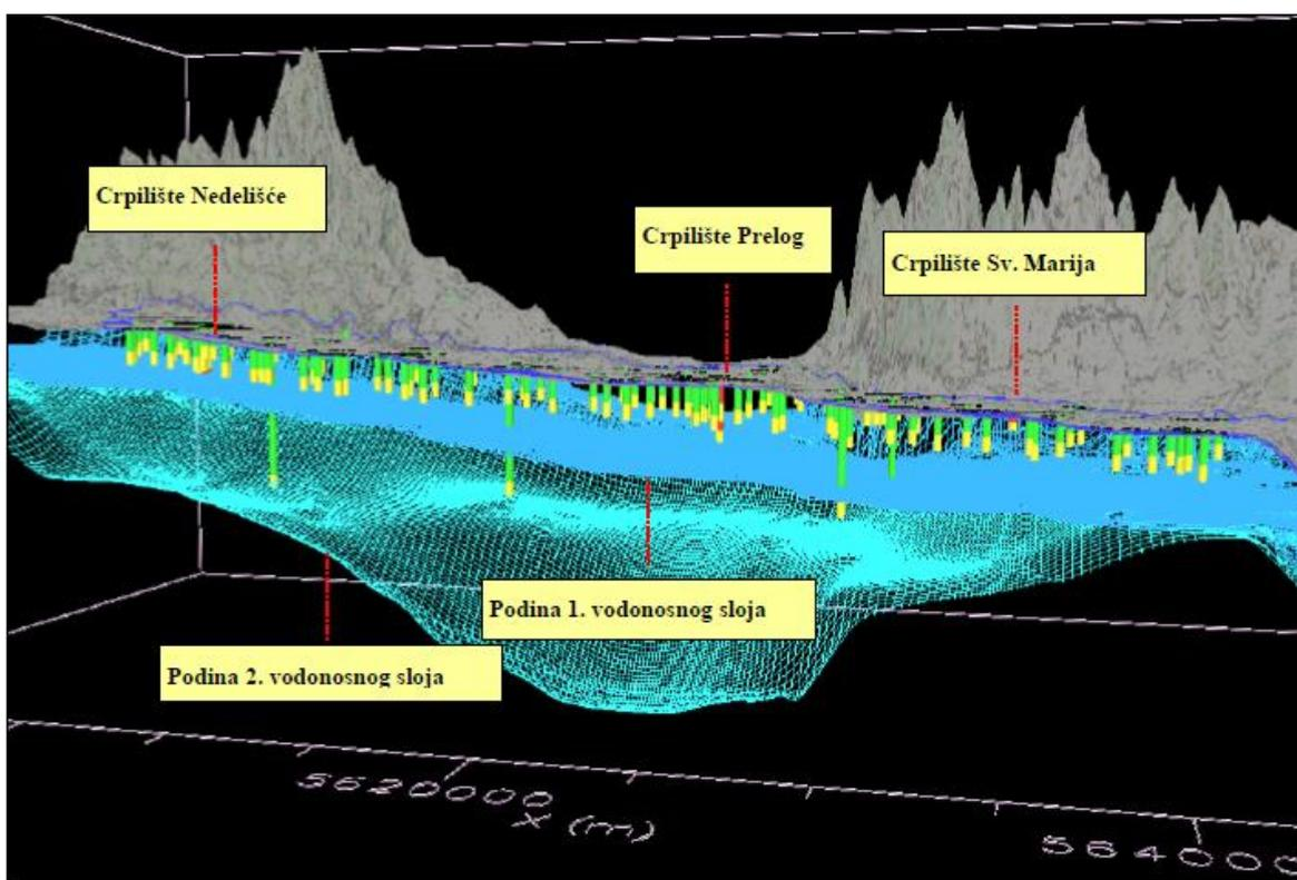
**Slika 2.2.** Trodimenzionalni model međimurskog vodonosnog sustava (presjek zapad-istok)
