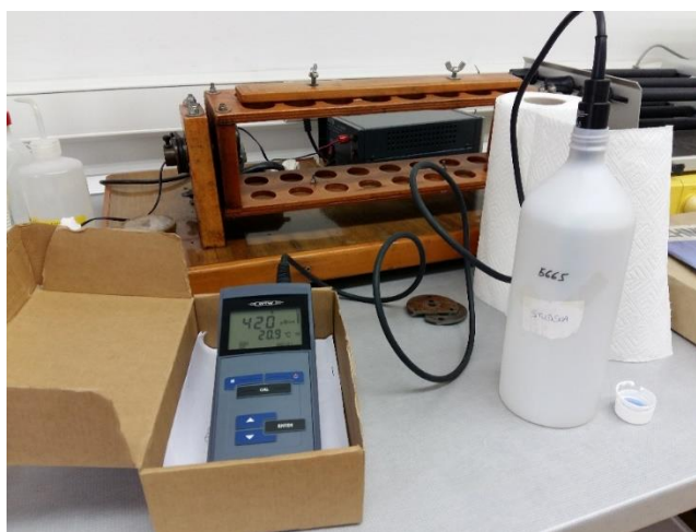
Slika 5.2. Mjerenje elektrovodljivosti uređajem Cond 3110
