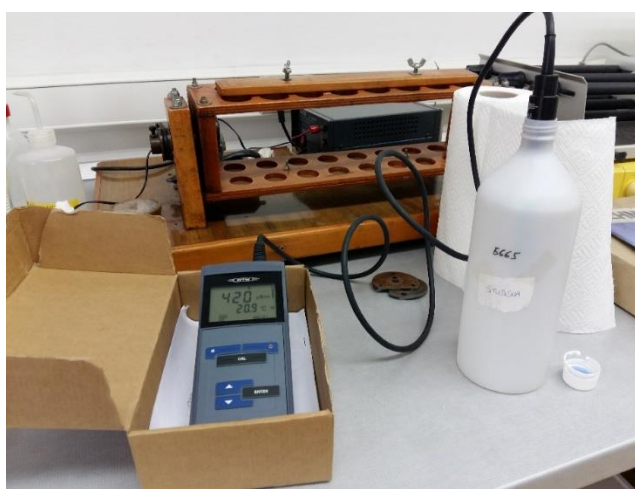
Slika 5.2. Mjerenje elektrovodljivosti uređajem Cond 3110
