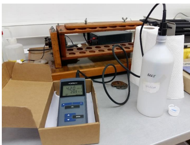
Slika 5.2. Mjerenje elektrovodljivosti uređajem Cond 3110
