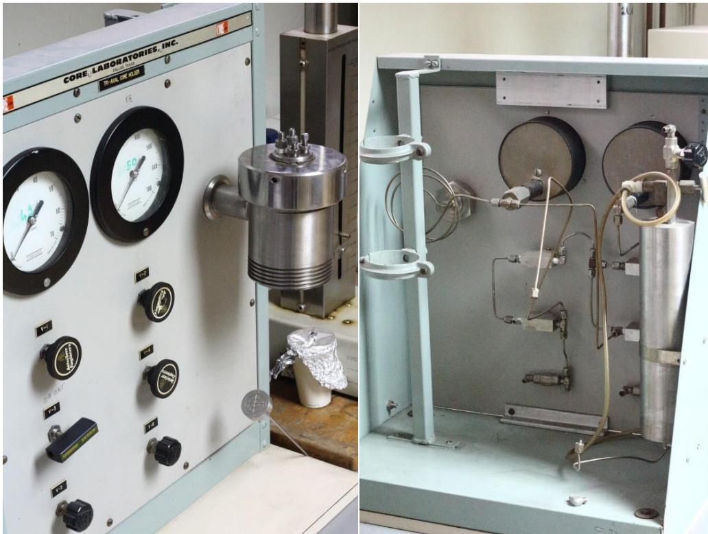
Slika 2-3 Aparatura za mjerenje relativne propusnosti, prikaz prednje i stražnje strane
