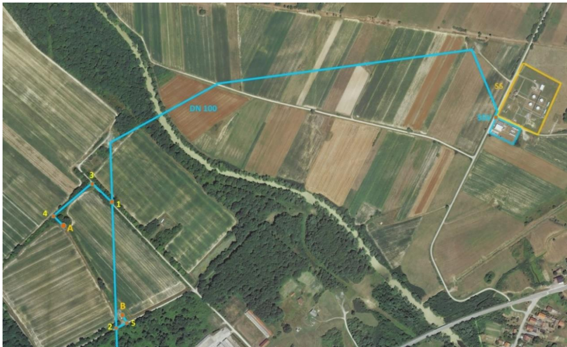
Slika 3-4. Trasa utisnog cjevovoda za utiskivanje vode
