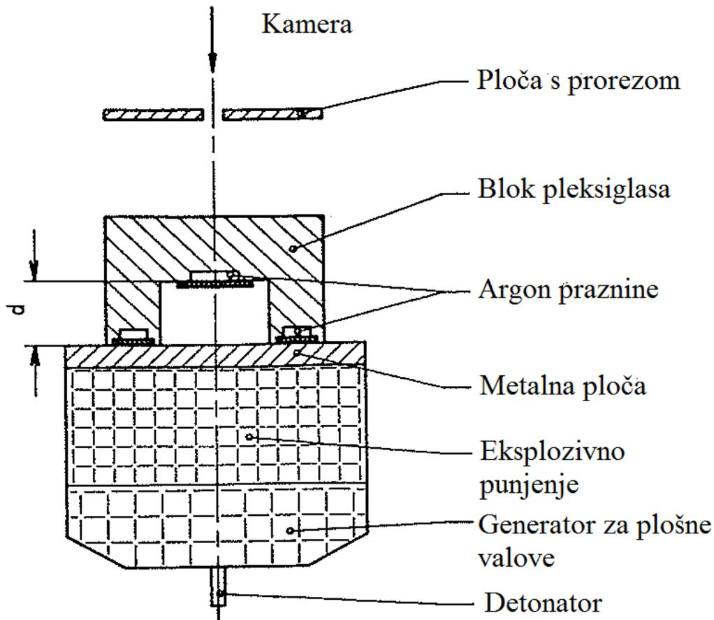
**Slika 5-3.** Određivanje brzine slobodne površine optičkom metodom (Sućeska, 1995).
