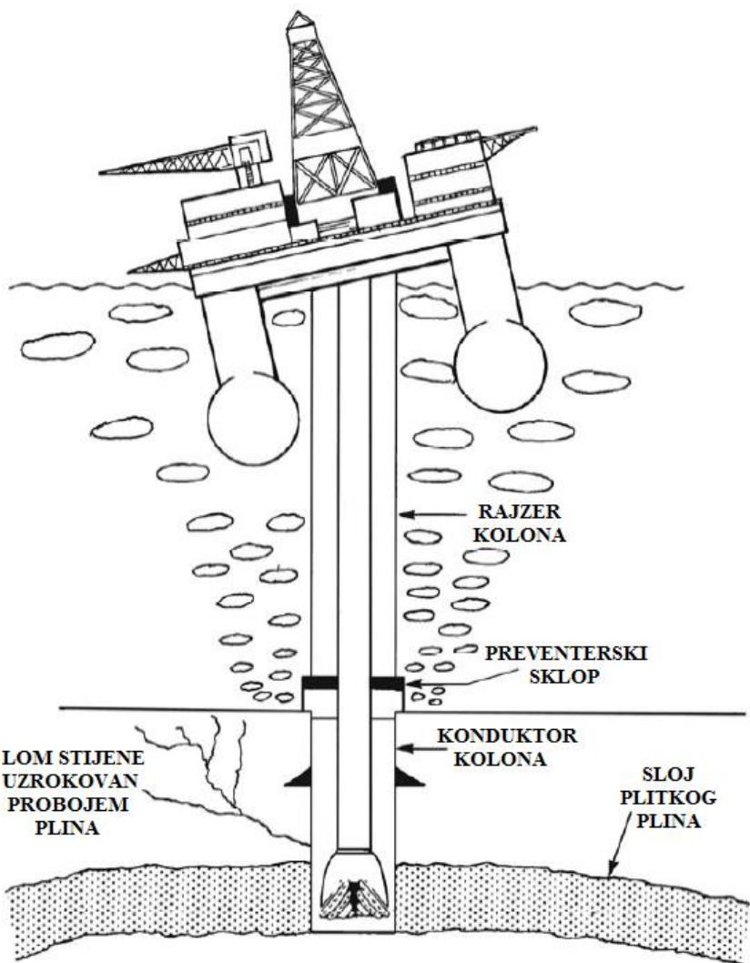
**Slika 3-5.** Proboj plina iza konduktor kolone (Rig Train, 2001).
