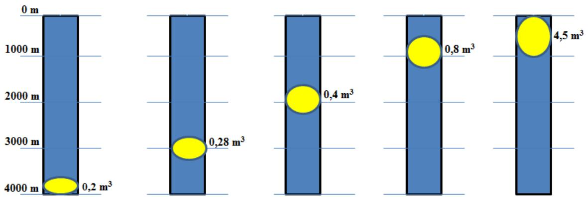
**Slika 3-6.** Shematski prikaz povećanja volumena (ekspanzije) plina.
