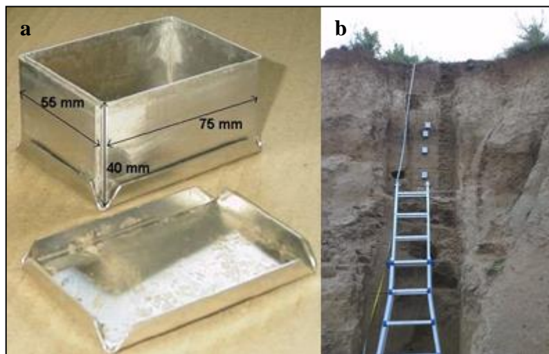
Slika 4-12. a) Prikaz Kubienine kutije (preuzeto s: http://www.thin.stir.ac.uk/wp-content/uploads/2008/06/kubienatin.jpg ); b) uzorkovanje tla na lokaciji Savudrija pomoću Kubieninih kutija (foto: G. Durn)
