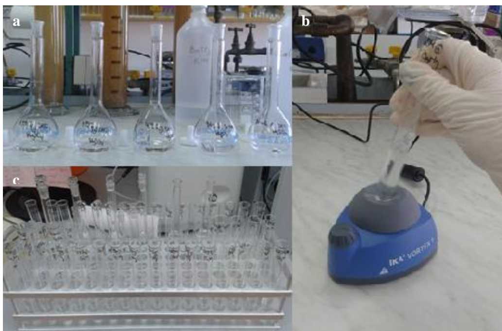
Slika 4-5. Priprema uzoraka za određivanje CEC-a i stupnja saturacije bazama a) Priprema uzoraka za titraciju s MgSO_4 ; b) mućkanje ekstrakta uzorka i reagensa pomoću uređaja IKA Vortex 1; c) 10 ml uzorka u epruvetama pripremljenih za analizu na AAS-u
