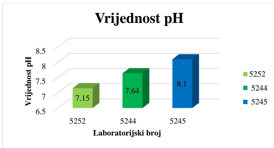
Slika 6-2. Dijagram laboratorijskih rezultata mjerena pH vrijednosti pomoću KCl-a
