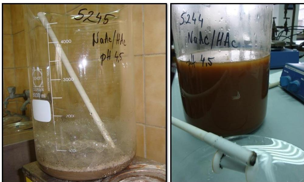
Slika 5-6. A) Stvaranje mjehurića  $\text{CO}_2$  prilikom otapanja karbonata primjenom pH 4,5 pufera NaAc/HAc, B) Nakupine željeza (kristalići magnetita) na teflonskom magnetu nakon micanja uzorka s magnetne mješalice gdje se do kraja vršilo otapanje karbonata primjenom pH 4,5 pufera NaAc/HAC (foto: Lucija Mihaljević)
