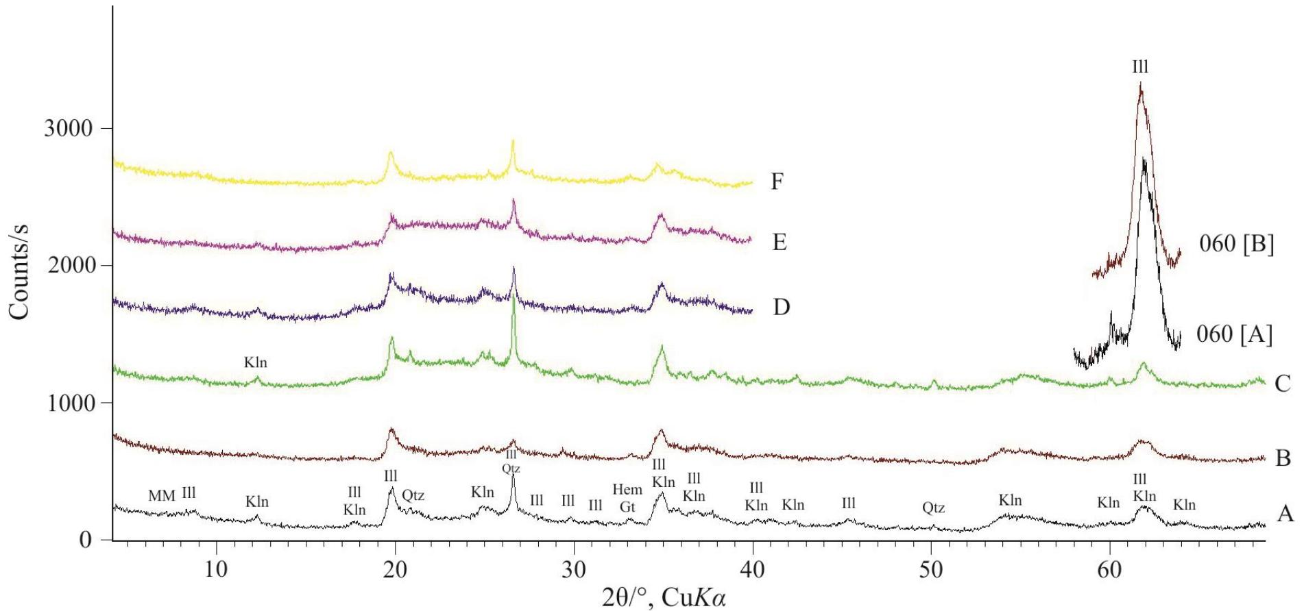
Slika 6-25. Prikaz difrakcijskih slika uzorka smeđeg tla na vagnencu (5252)
