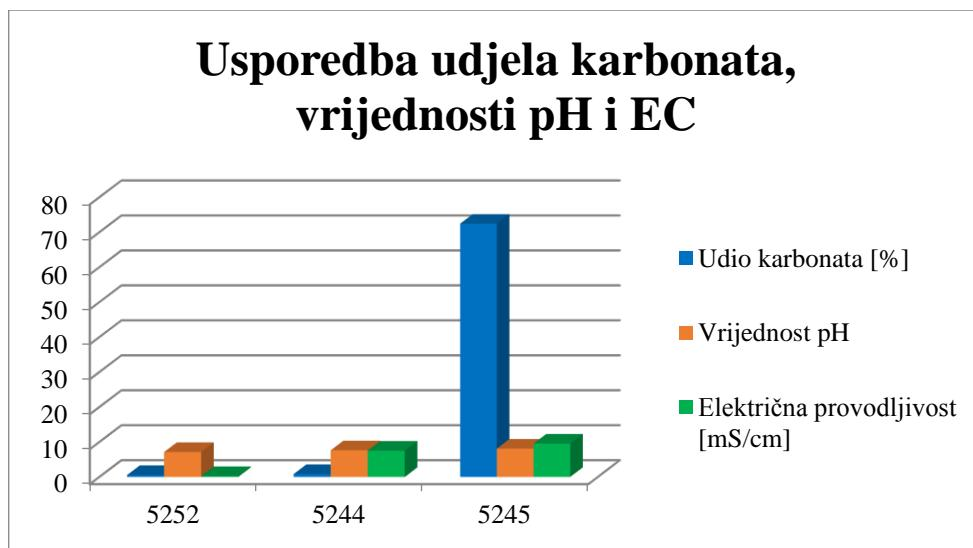
Slika 7-3. Usporedba udjela karbonata, vrijednosti pH te električne provodljivosti kroz uzorke
