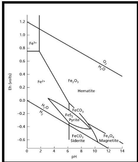
Slika 7-1. Eh-pH dijagram s poljima stabilnosti dvovalentnog i trovalentnog željeza, hematita, siderita, piriti i magnetita (Tucker, 2001)
