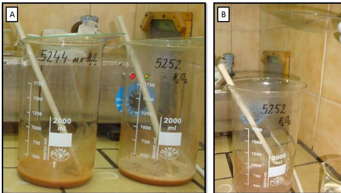
**Slika 5-8.** A) Tretiranje uzoraka 5244 i 5252 30% vodikovim peroksidom radi uklanjanja organske materije,
