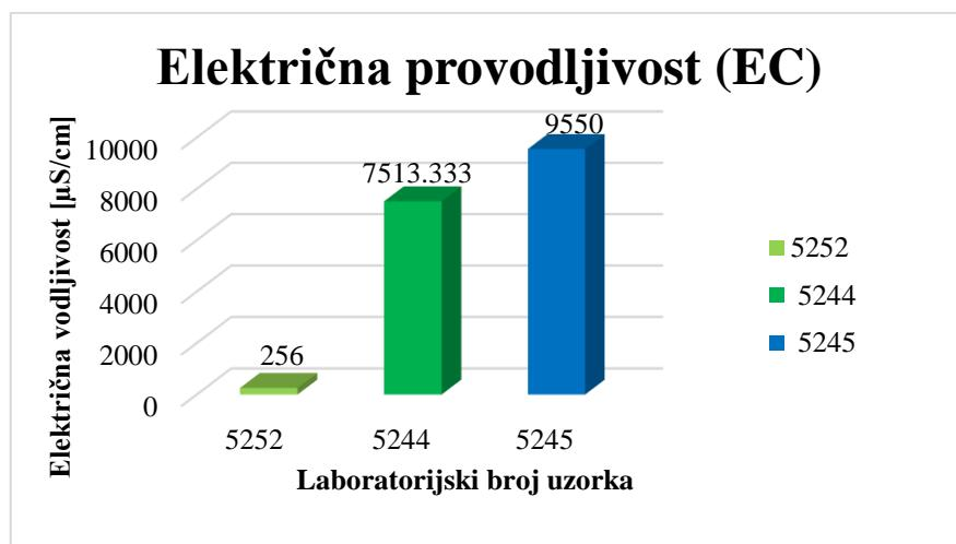
Slika 6-3. Dijagram laboratorijskih rezultata električne provodljivosti po uzorcima
