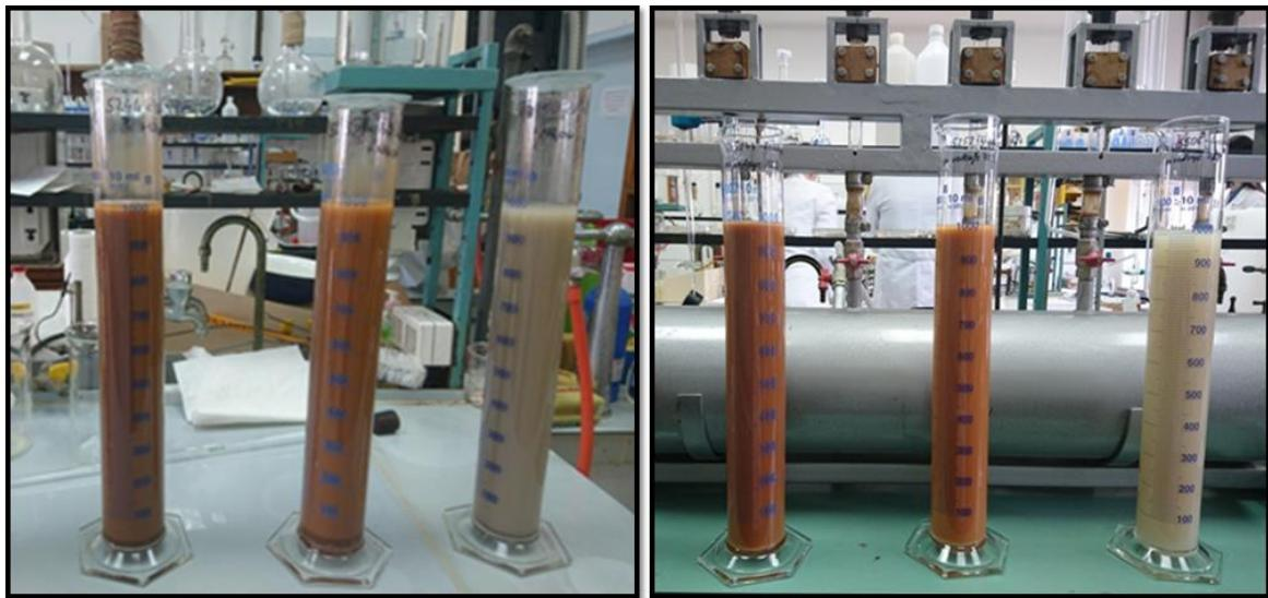
**Slika 5-13.** Gravitacijsko taloženje čestica u suspenziji primjenom Stokes-ovog zakona radi izvlačenja frakcije  $<2 \mu\text{m}$  (lijevo) te frakcije  $< 1 \mu\text{m}$  (desno) (foto: Lucija Mihaljević)
