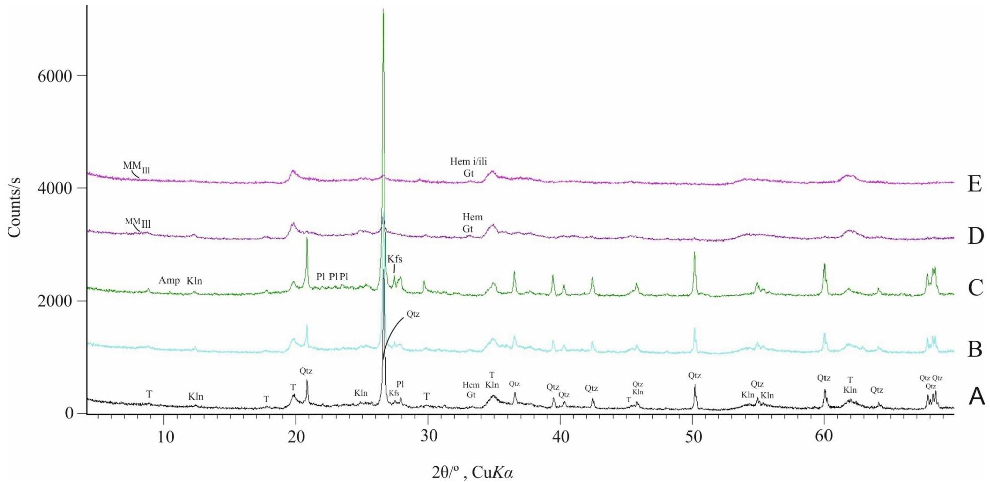
**Slika 6-24.** Prikaz difrakcijskih slika uzorka smeđeg tla na vapnenu (5252)
