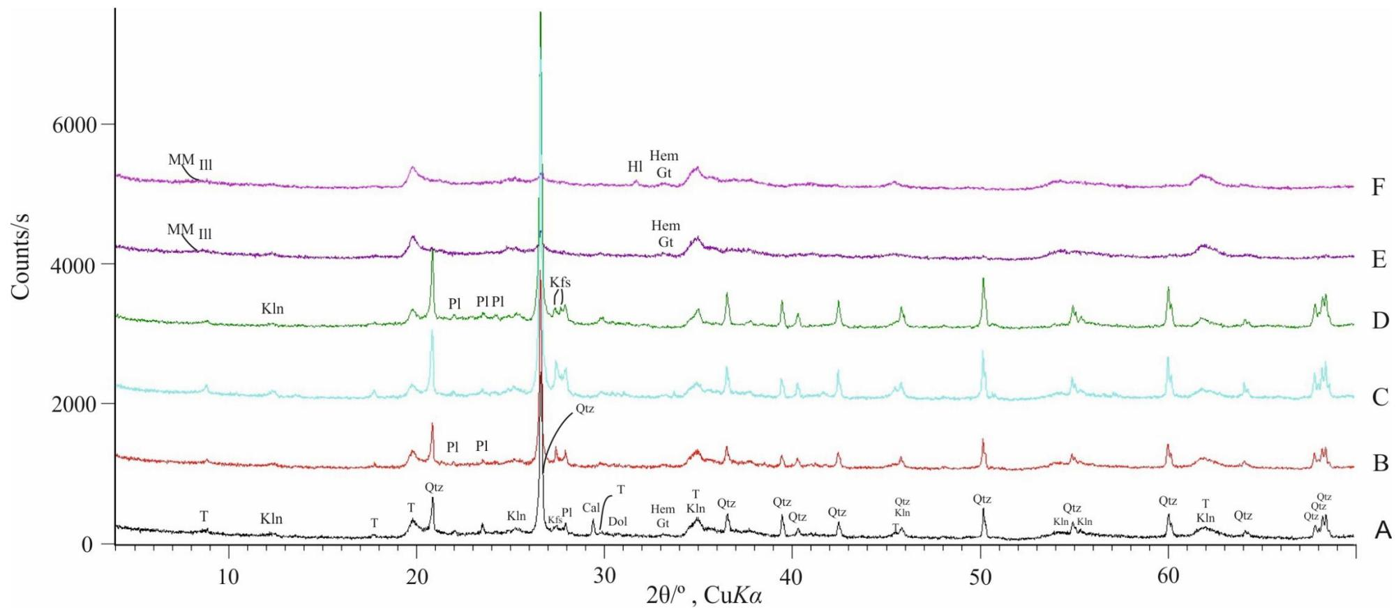
Slika 6-26. Prikaz difrakcijskih slika uzorka koluvija (5244)
