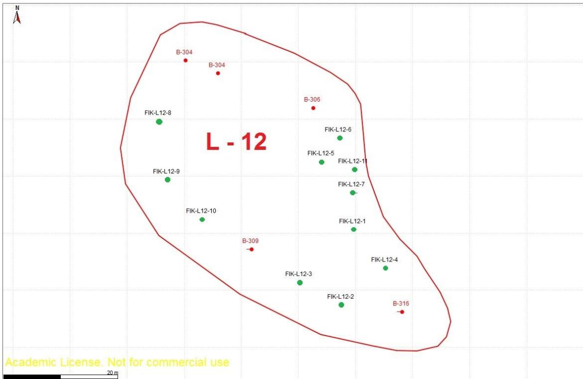
**Slika 5.12.** Postavljanje fiktivnih bušotina (FIK) na primjeru ležišta L-12. Bušotine označene crvenom bojom su prave bušotine na boksitu, a bušotine označene zelenom bojom su fiktivne bušotine.
