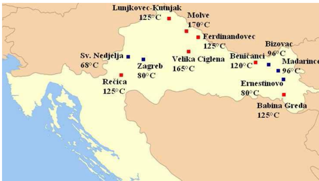
Slika 6-1. Prikaz geotermalnih izvora u RH izraženim vrijednostima temperatura nalazišta izraženim u °C (Šumonja, 2011.)
