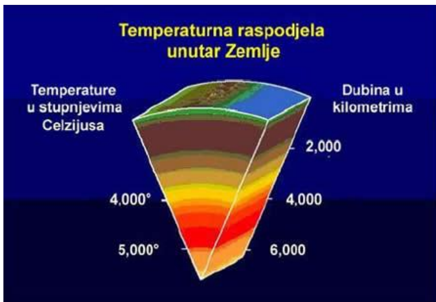
Slika 1-1. Prikaz temperature zemljine unutrašnjosti ( http://www.obnovljivi.com , 2010.)
