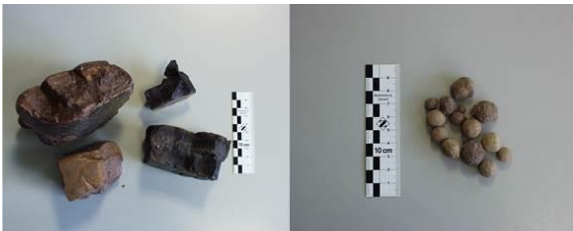
Slika 4-8. Oblik klinkera kod procesa taljenja (lijevo) i procesa sinteriranja (desno).
