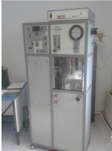
Slika 7.1. Rotacijski viskozimetar FANN 50 RCO
