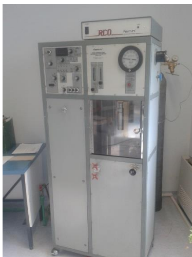
Slika 7.1. Rotacijski viskozimetar FANN 50 RCO
