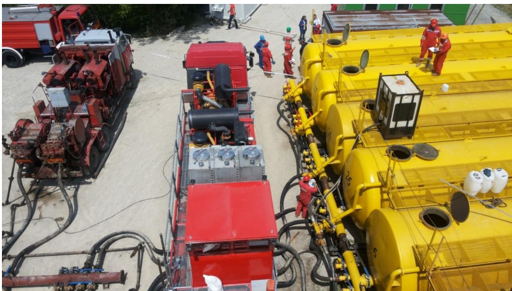
Slika 2.4. Mješalica za pripremu fluida za frakturiranje (Škrinjarić, 2015)
