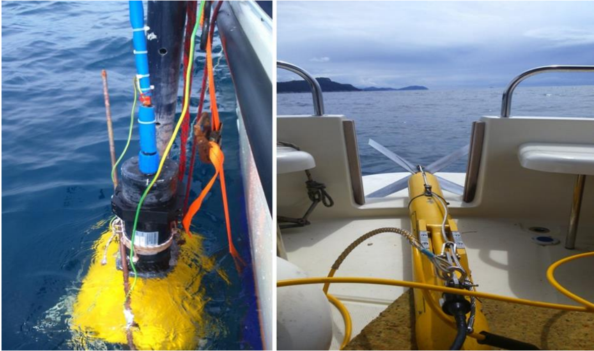
Slika 3.1. Geološki dubinomjer (engl. sub – bottom profiler ) lijevo, Panoramski dubinomjer (engl. side – scan sonar ) desno
