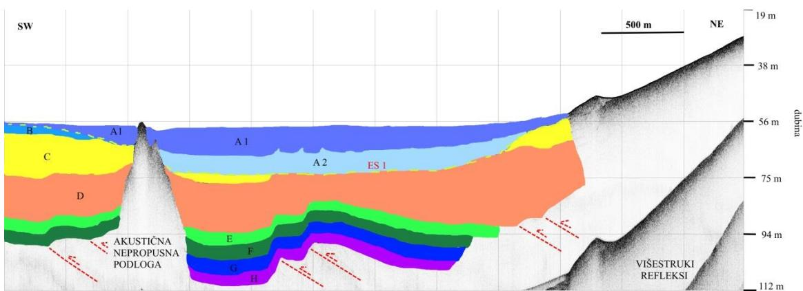
Slika 4.15. Interpretirani seizmički profil 22\_L10 sa sukcesijom bora kao posljedicom reversnog rasjedanja u boranom navlačnom pojasu u kojem se nalazi bazen Koločepskog kanala (usmeno priopćenje B. Tomljenović, 2017)
