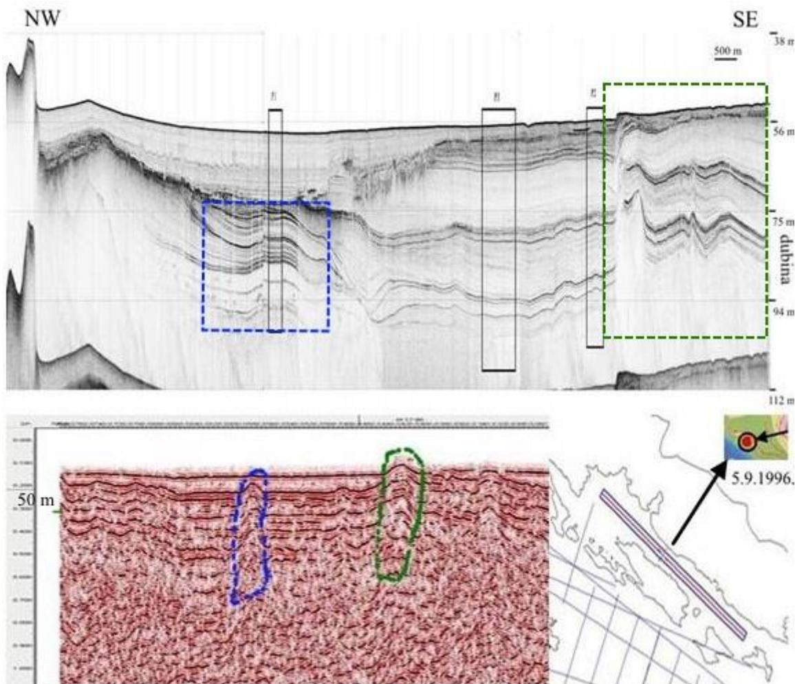
Slika 5.8. Prikazani rasjedi na dubokom seizmičkom profilu (INA-naftaplin, ustupljeno od Agencije za Ugljikovodike) i na neinterpretiranom spojenom seizmičkom profilu (26\_L8, 22\_L16 i 22\_L17) i epicentar potresa iz 1996.
