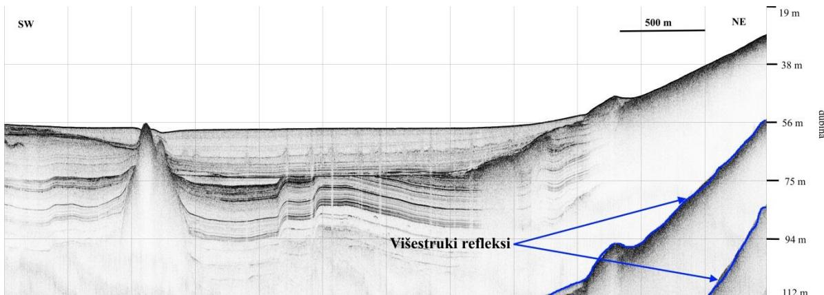
Slika 3.3. Seizmički profil 22\_L10 s vidljivim višestrukim refleksom, Koločepski zaljev.
