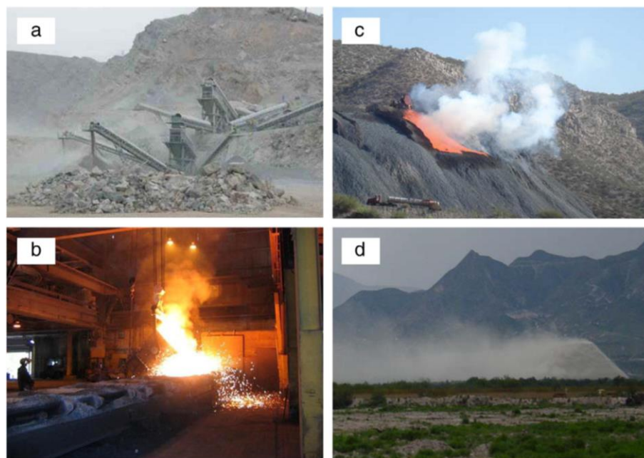
Slika 2-2. Emisije grubih čestica generirane: (a) drobljenjem i mljevenjem rude i (d) iz prašine koju raznosi vjetar s rudničkih odlagališta; fine čestice ( < 2 \mu\text{m} ), prašina nastala: (b) taljenjem rude i (c) na odlagalištu troske (Csavina et al., 2012 i reference u njemu).
