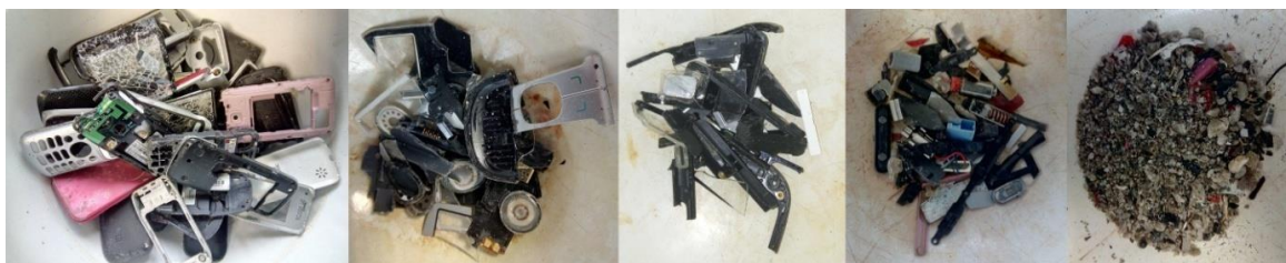
Slika 7-2 Klase plastičnih kućišta nakon sitnjenja u udarnoj drobilici (redom s lijeva na desno): +20 mm, 20/10 mm, 10/7 mm, 7/4 mm, -4 mm
