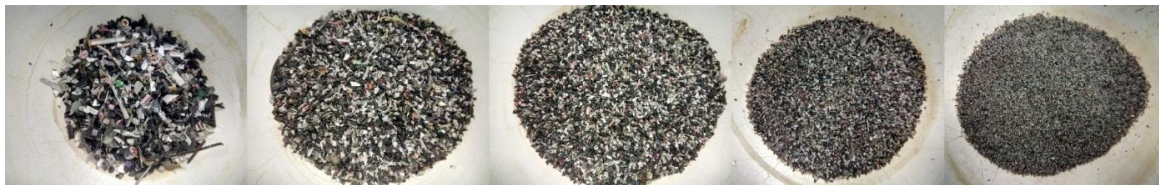
Slika 7-6 Klase plastičnih kućišta nakon reznog mlina (redom s lijeva na desno): 4/3,15 mm, 3,15/2 mm, 2/1 mm, 1/0,5 mm, -0,5 mm
