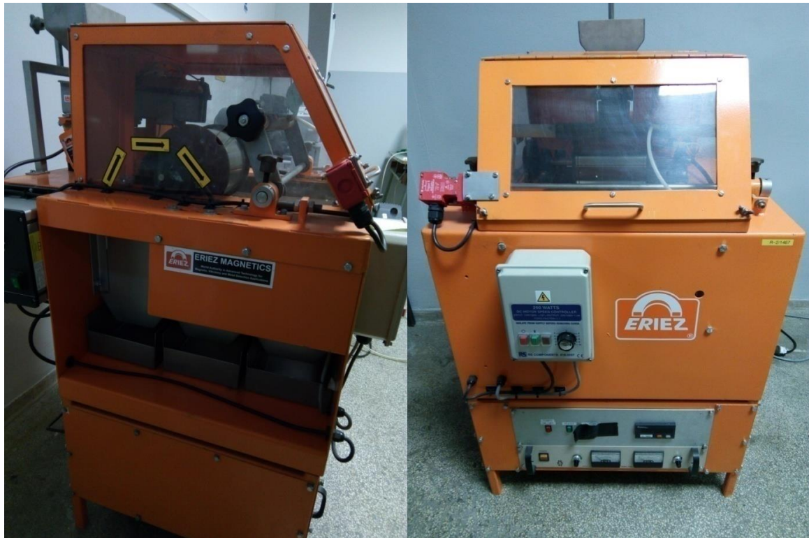
Slika 6-5 Elektrostatički separator Eriez Magnetics HT-150
