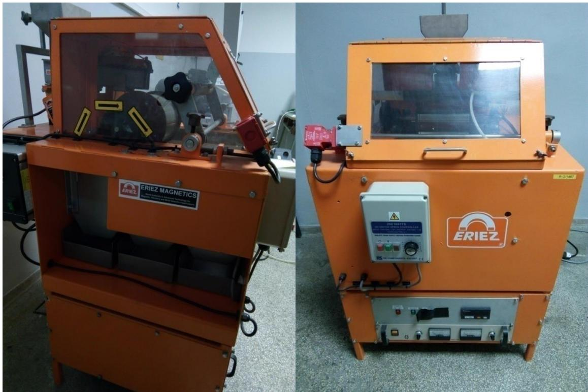
Slika 6-5 Elektrostatički separator Eriegz Magnetics HT-150
