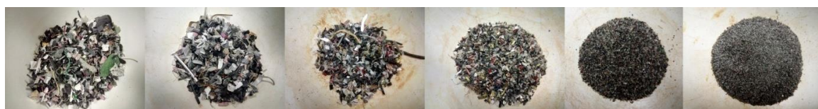
Slika 7-4 Klase plastičnih kućišta nakon sitnjenja u drobilici čekićari (redom s lijeva na desno): +4 mm, 4/3,15 mm, 3,15/2 mm, 2/1 mm, 1/0,5 mm, -0,5 mm
