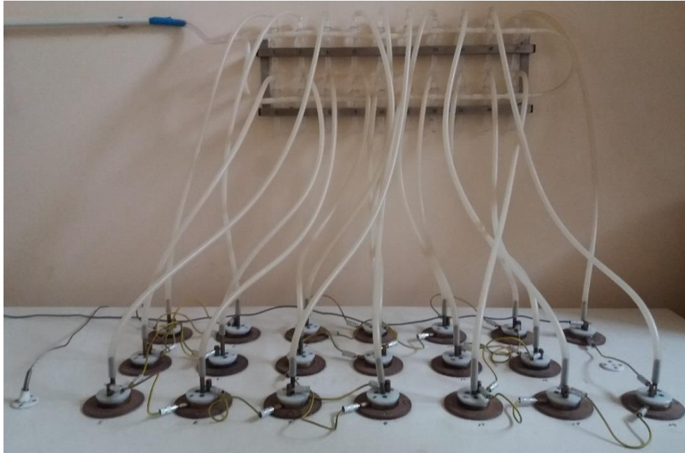
Slika 6-4. Uređaj za elektrolitičko obogaćivanje
