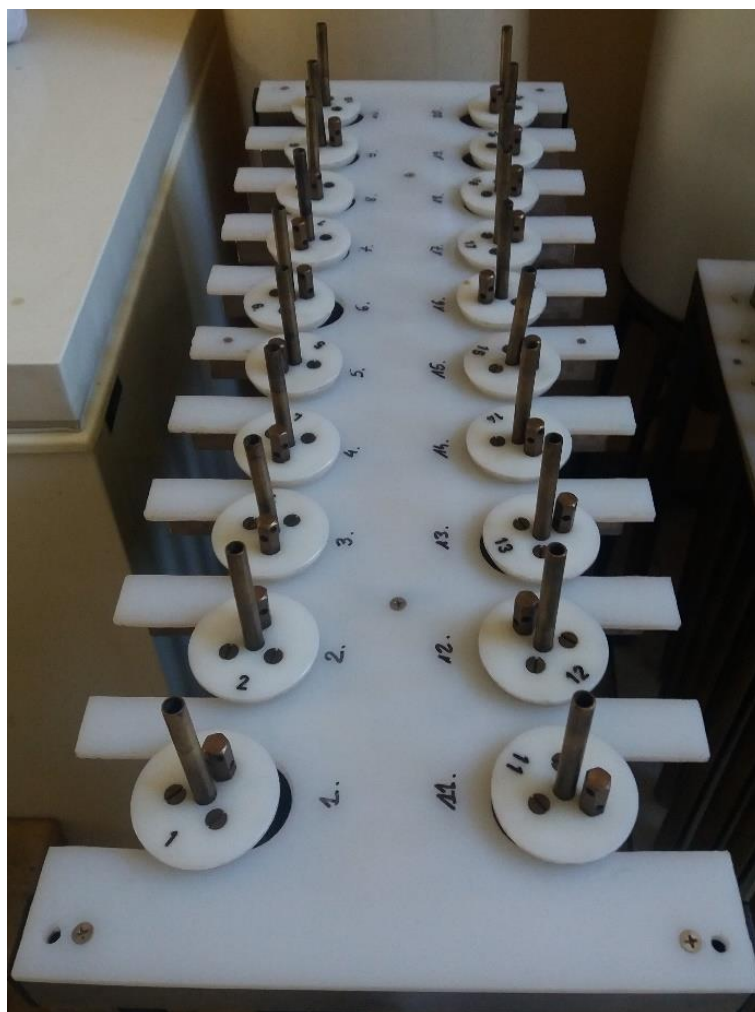
Slika 6-3. Čelije za elektrolizu vode
