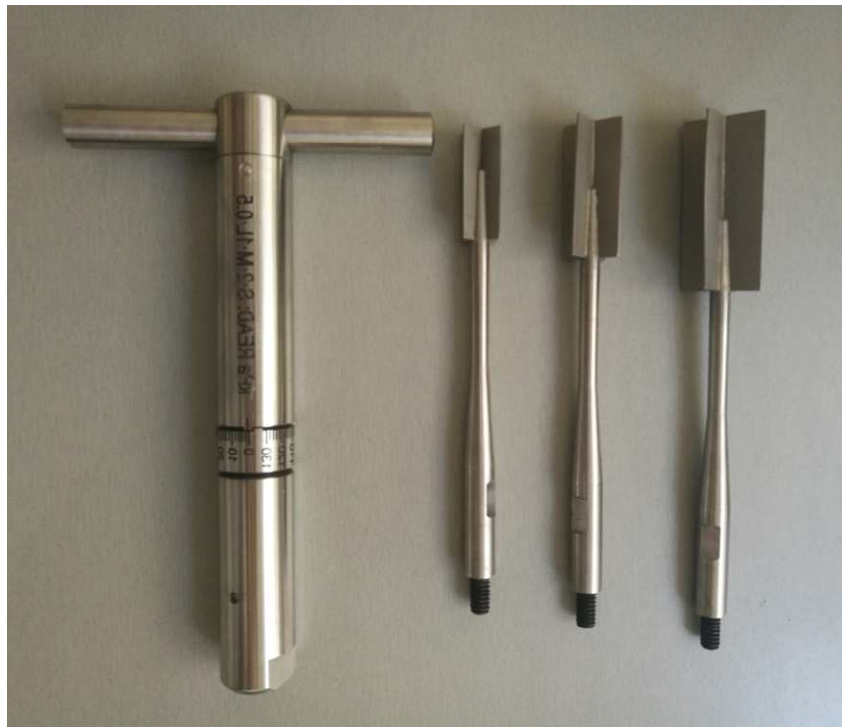
Slika 4-3 Sonda s pripadajućim krilcima
