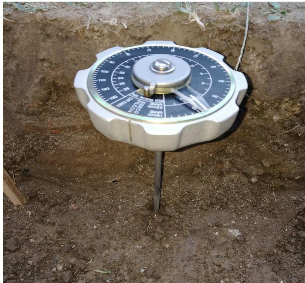
Slika 6-4 Krilna sonda utisnuta u tlo
