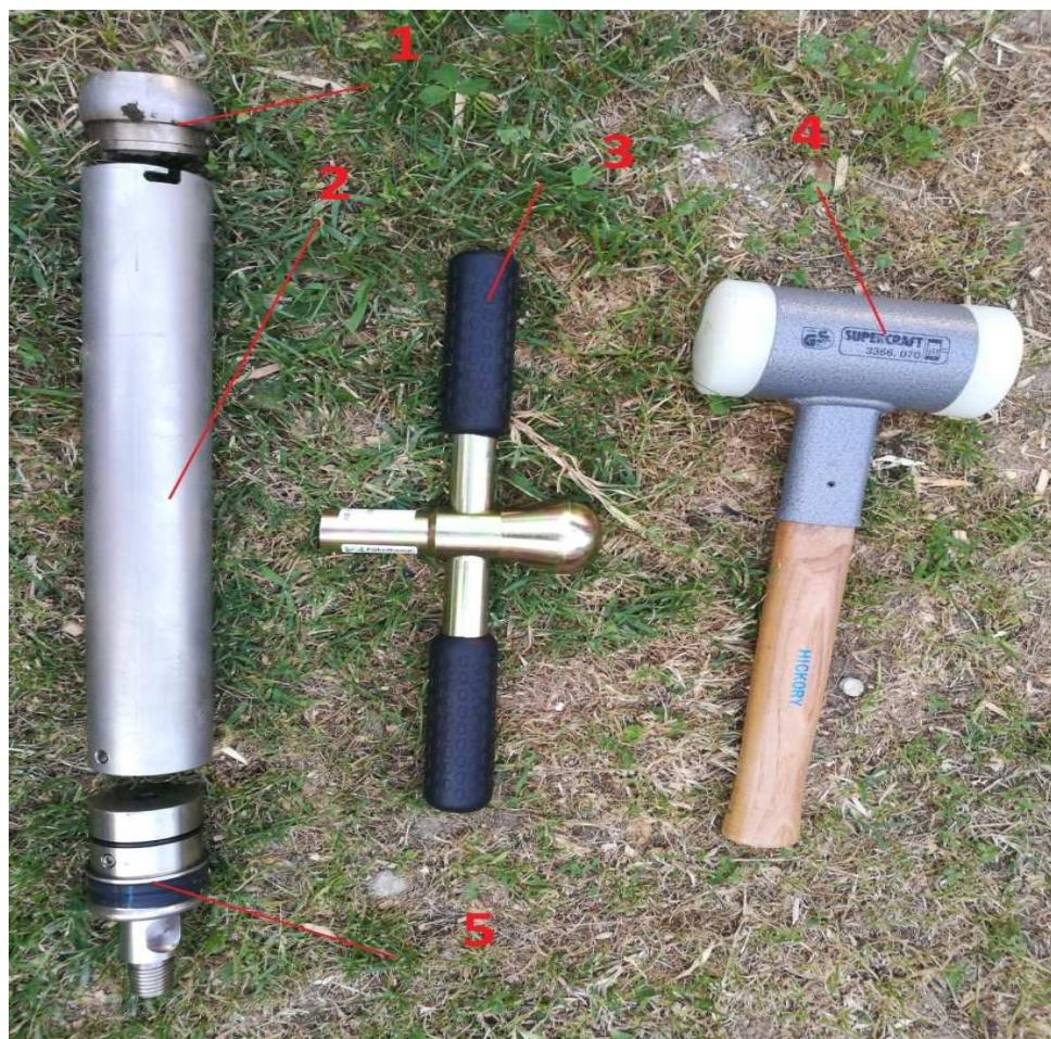
Slika 6-9 Uzorkivač sa pripadajućom opremom
