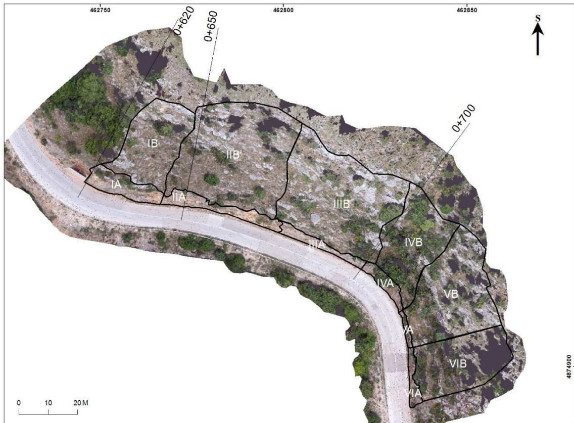
Slika 4.1. Dionica županijske ceste ŽC 6055 (Oklaj-Kistanje) podijeljena na inženjerskogeološke zone. Zone A obuhvaćaju pokos zasjeka stijenske mase, dok zone B obuhvaćaju prirodni pokos stijenske mase
