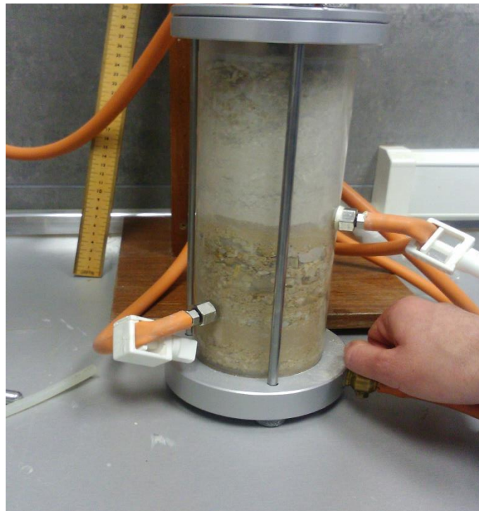
Slika 6.6. Saturacija uzorka u permeametri
