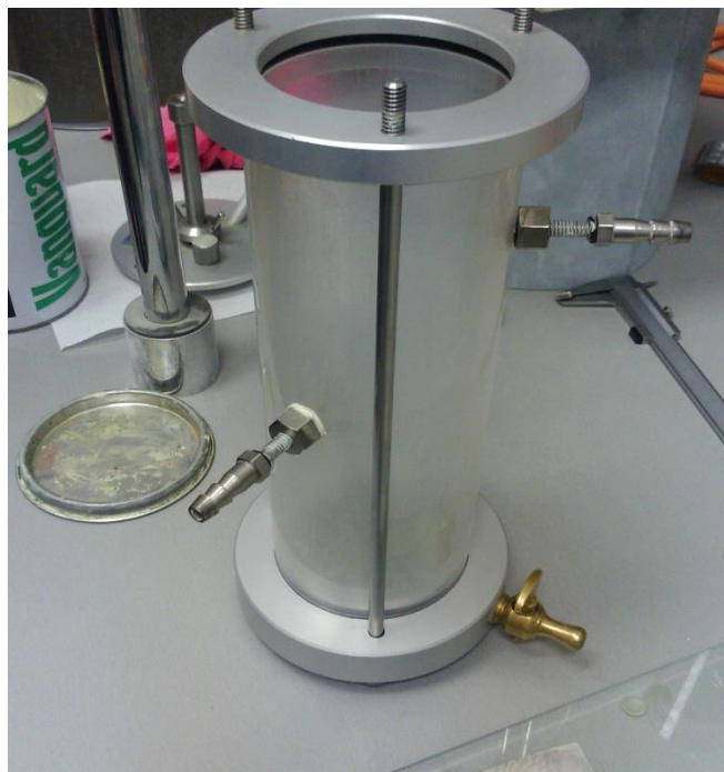
Slika 6.3. Permeametar prije ugradnje uzorka
