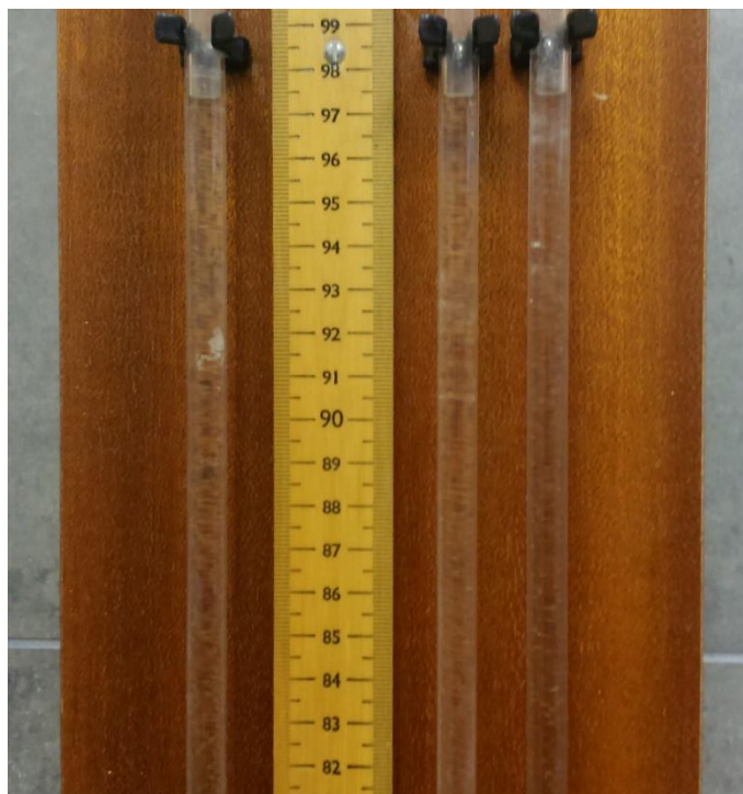
Slika 6.7. Početno stanje u manometarskim cjevčicama
