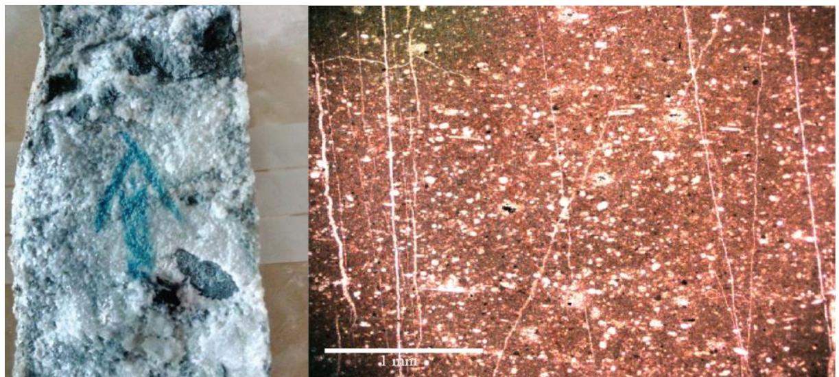
**Slika 6.4.** Uzorak iz sloja 9 bogat kalcitom. Strelica na uzorku prikazuje orientaciju uzorka prilikom uzimanja iz sloja (lijevo), te mikroskopski pregled uzorka bogatog kalcisferama (desno).
