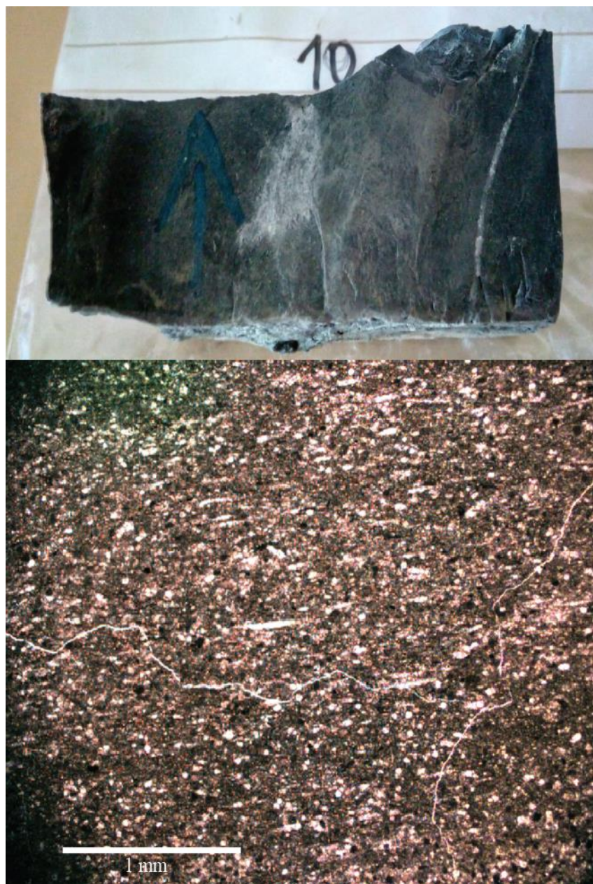
Slika 6.5. Uzorak iz sloja 10 sa tragovima trošenja i kalcitnim žilama (gore), te mikroskopski prikaz na kojem su vidljive brojne kalcisfere i fragmenti bodljikaša(dolje).
