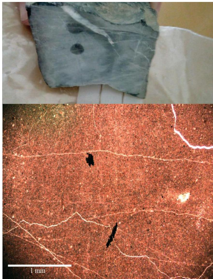
**Slika 6.8.** Nešto veće žile kalcita vidljive na brušenom dijelu uzorka (gore), madston sa zrnima piroita, vidljiv u mikroskopskom preparatu (dolje).
