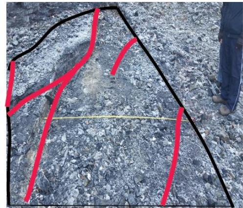
Slika 7.6b. Označene pukotine i konture površine
