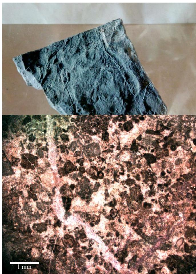
**Slika 6.2.** Uzorak tamnosive boje sa nejasnim površinskim trošenjem (gore), te mikroskopski uzorak raznolikog sastava, mikritnog i sparitnog veziva, s brojnim intraklastima i alokemima te pukotina (dolje).
