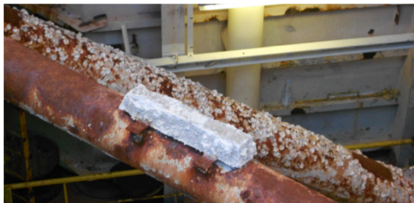
Slika 5-12. Iskorištene žrtvene anode (Crosco, 2015c)
