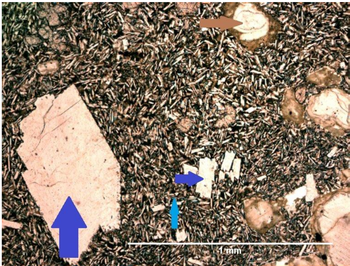
Slika 5.3.17. Mikrofotografija uzorka ZB – 3 kojom se ilustrira sastav bazalta. Tamno plave strelice prikazuju fenokristale plagioklasa, svijetlo plava strelica prikazuje klinopiroksen u sastavu vulkanske osnove. Smeđa prikazuje nodule sekundarno ispunjenu kalcitom.
