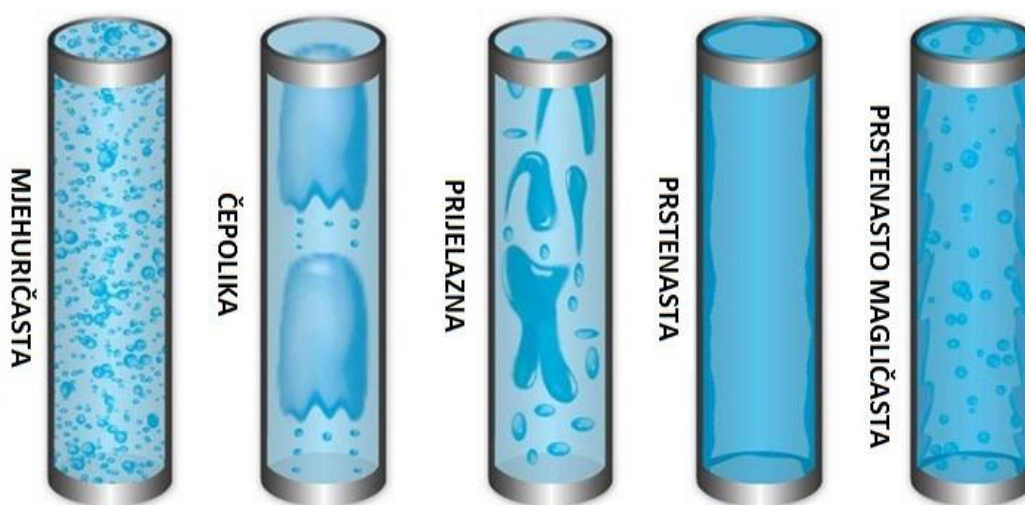
Slika 3-1. Strukture protjecanja za vertikalne bušotine (Bratland, 2010)
