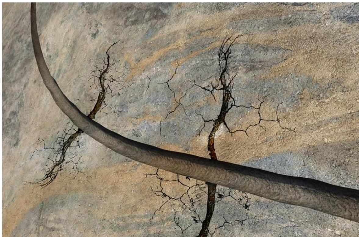
Slika 3-1. Pukotine nastale premašivanjem tlaka frakturiranja ([www.bakerhughes.com](http://www.bakerhughes.com), 2015)
