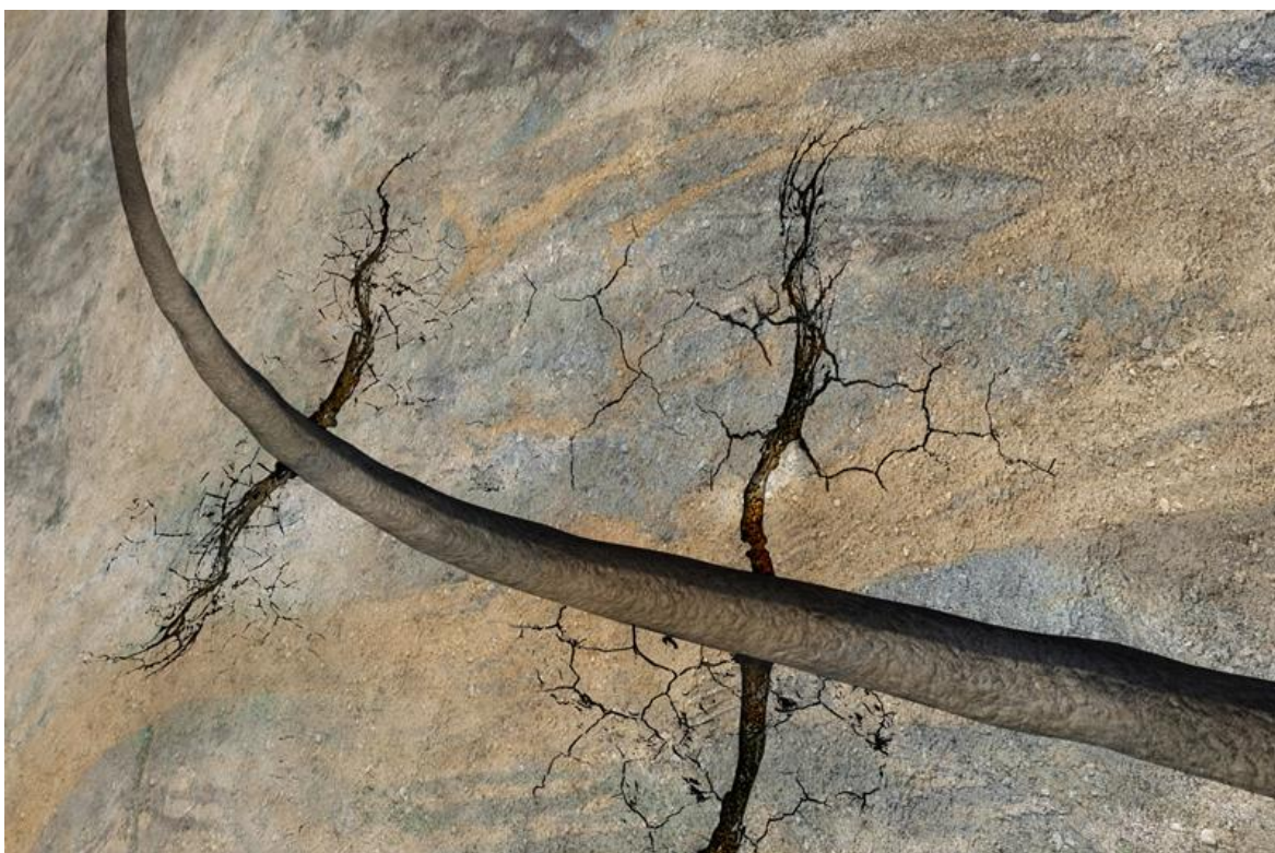
Slika 3-1. Pukotine nastale premašivanjem tlaka frakturiranja (www.bakerhughes.com, 2015)
