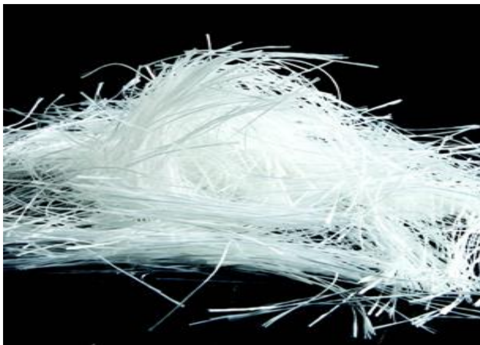
Slika 6-3. Svitak silikatnih vlakana (www.acit-usa.com, 2013)
